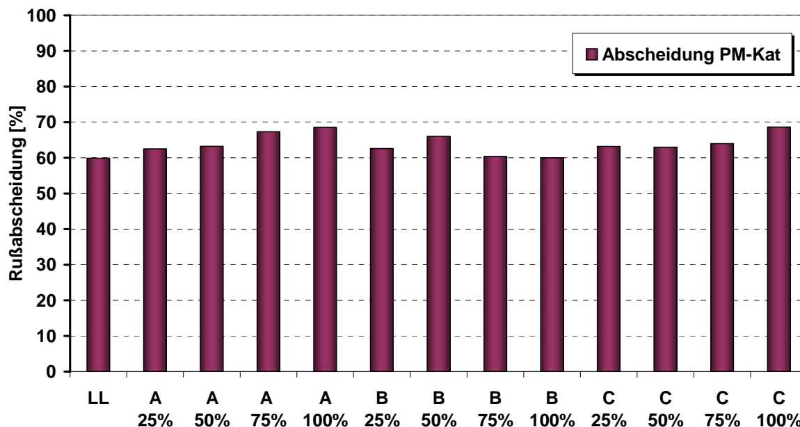
Abbildung 103 Rußumsatz des PM-KAT-Systems im ESC berechnet aus den FSN-Werten (AVL 415S).
