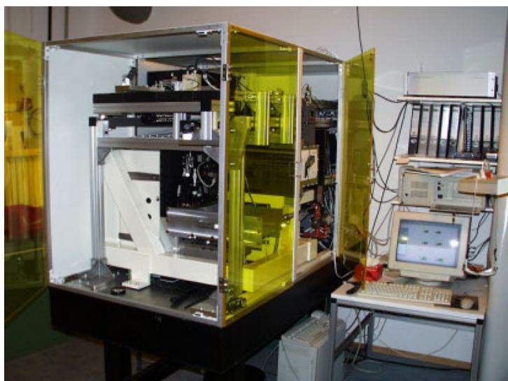
Bild 6.32 Prototyp der Mikro-Stereolithografiemaschine
