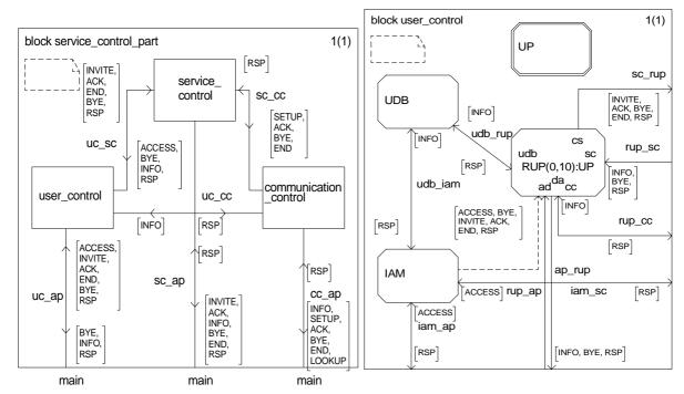
Abbildung 7.3: Spezifikation der Dienstebene des Signalisierungssystems
