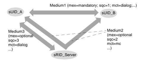
Abbildung 5.12: (Graphische) Beschreibung einer Kommunikationsbeziehung durch den Media Connection Graph
