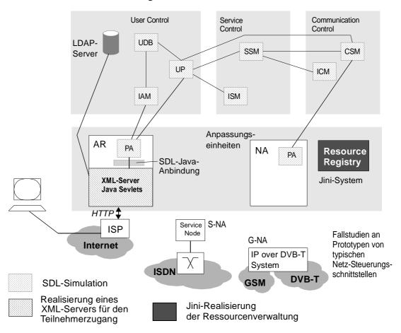
Abbildung 7.1: Übersicht über die prototypische Realisierung
