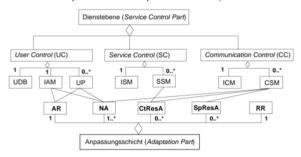
Abbildung 6.1: UML-Klassendiagramm der Anpassungsschicht mit Bezug zu den Komponenten der Dienstebene
