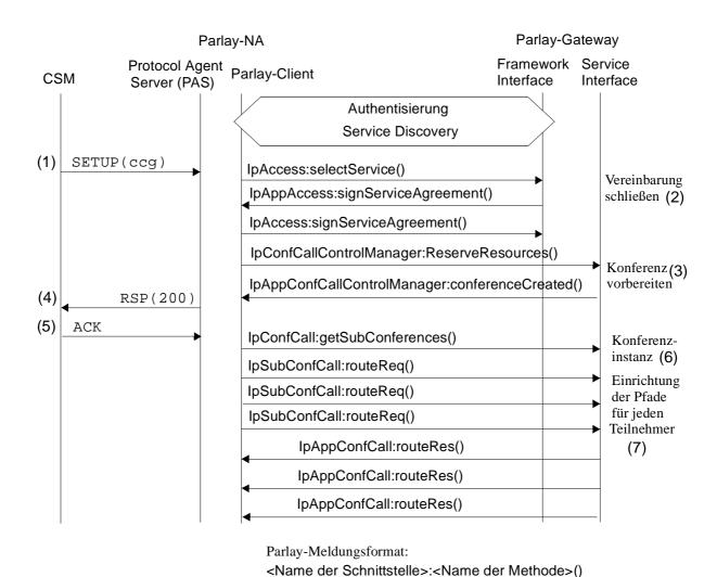
Abbildung 6.5: Signalablauf für eine SETUP-Nachricht in einem Parlay-NA
