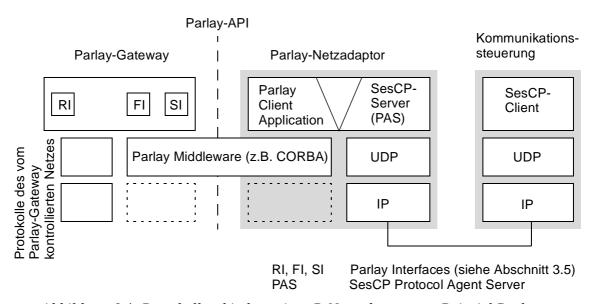
Abbildung 6.4: Protokollarchitektur eines P-Netzadaptors am Beispiel Parlay
