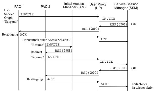
Abbildung 5.11: Signalablauf für eine Änderung der laufenden Dienstkonfiguration mit Suspend und Resume (Dienst-Mobilität)
