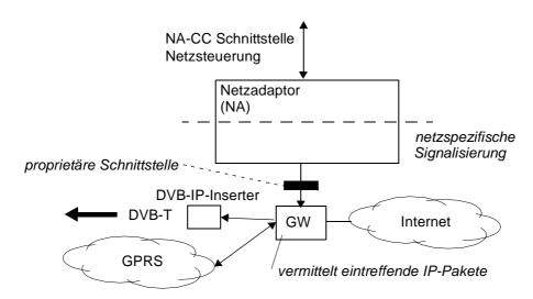
Abbildung 6.8: G-NA am Beispiel eines Hybridsystems
