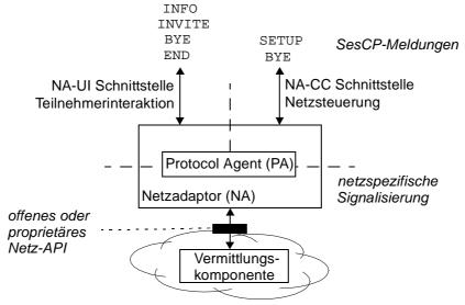
Abbildung 6.2: Modell eines Netzadaptors
