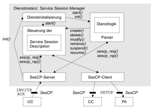
Abbildung 5.9: Innere Struktur der Dienststeuerung
