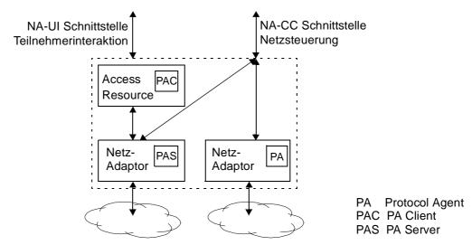
Abbildung 6.9: Verknüpfung der Access Resource mit Netzadaptoren
