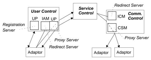
Abbildung 5.2: Realisierung des Signalisierungsprinzips mit SIP
