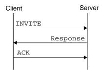
Abbildung 5.3: Three-Way-Handshake bei SIP
