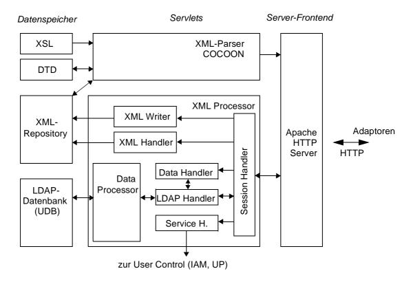
Abbildung 7.2: Programmstruktur der Access-Ressource
