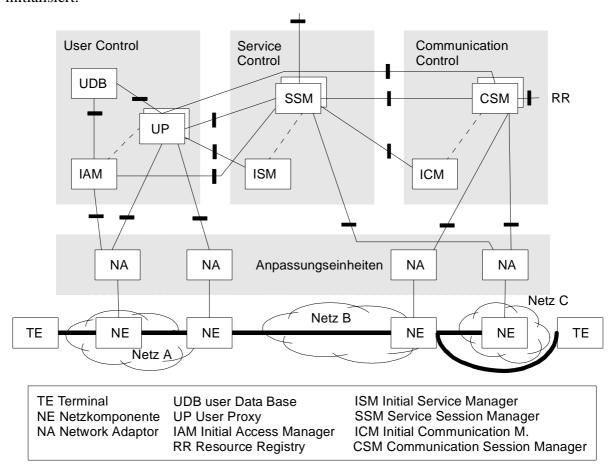
Abbildung 4.13: Komponenten und Schnittstellen der SAMSON-Dienstarchitektur
