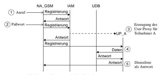
Abbildung 4.18: Beispielablauf für die Registrierung
