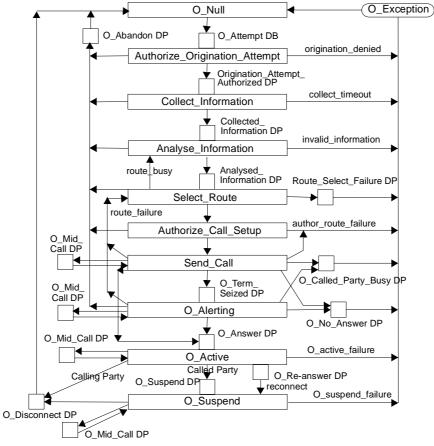
Abbildung 3.4: BCSM IN CS-2 Rufende Seite mit Triggerpunkten [Q.1228]
