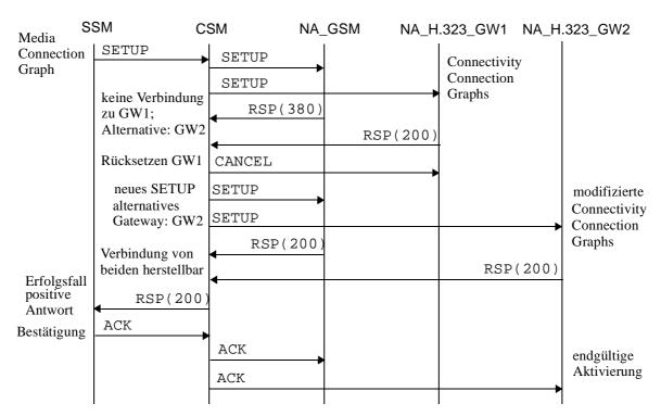
Abbildung 5.17: Signalablaufdiagramm für die Kommunikationssteuerung
