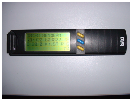
Abbildung 4.14: Handprogrammiergerät der Viterra Energy Services AG
