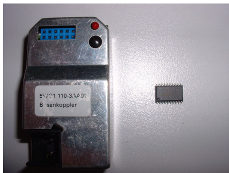
Abbildung 4.19: Buskoppler zum Geräteeinbau und TP-UART Chip
