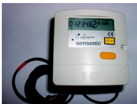
Abbildung 2.10: Elektronischer Wärmehzähler vom Typ „Sensonic“, Quelle: Viterra Energy Services AG
