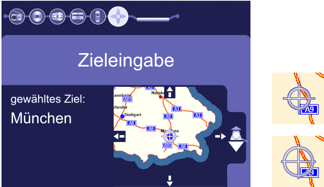
Abb. 6.8: Grafische Auswahl eines Navigationszieles durch diskrete und kontinuierliche Gesten. GECoM (links) und Fadenkreuz-Cursor im diskreten (rechts oben) bzw. vergrößert im kontinuierlichen Modus (rechts unten).
