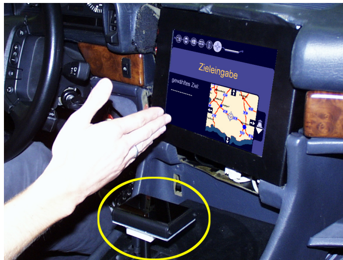
Abb. 7.4: Sensoranordnung für Handgestenerkennung (links), die in den Betätigungsgriff der Gangschaltung integriert wurde (rechts).
