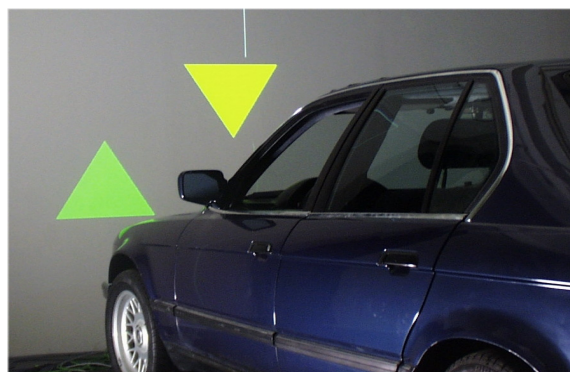
Abb. 5.1: Fahrsimulator und Projektion einer abstrakten Fahraufgabe (oberes Dreieck: Soll-Marke; unteres Dreieck: Ist-Marke).
