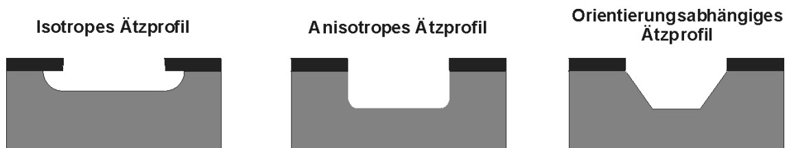
Abb. 2.6: Typische (idealisierte) Profilformen verschiedener Ätztechnologien: Ideal isotropes Ätzprofil; der Materialabtrag erfolgt in alle Richtungen gleichmäßig. Ideal anisotropes Ätzprofil; der Materialabtrag senkrecht zur Waferoberfläche ist sehr viel größer als in lateraler Richtung. Orientierungsabhängiges Ätzprofil; Schnitt entlang einer \{110\} -Ebene eines Wafers mit \langle 100 \rangle -Oberflächenorientierung; typischer Querschnitt eines sogenannten V-Grabens, gebildet aus stabilen \{111\} -Flächen.
