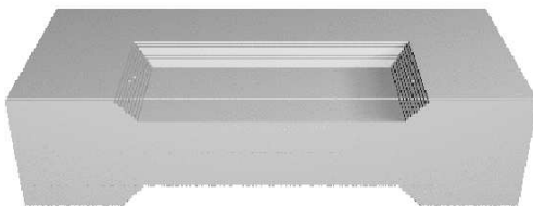
Abb. 5.11 a): Auf der Ober- und Unterseite des Wafers bildet sich eine Ätzgrube mit dem {100}-Boden und stabilen {111}-Seitenflächen.
