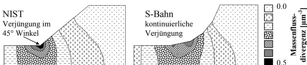
Abb. 2-11: Finite-Elemente-Simulation der Massenflussdivergenzen unter Stressbedingungen bei Leitbahnen mit unterschiedlichen Anschlussgeometrien (links: NIST-Struktur, rechts: S-Bahn-Struktur) [60].
