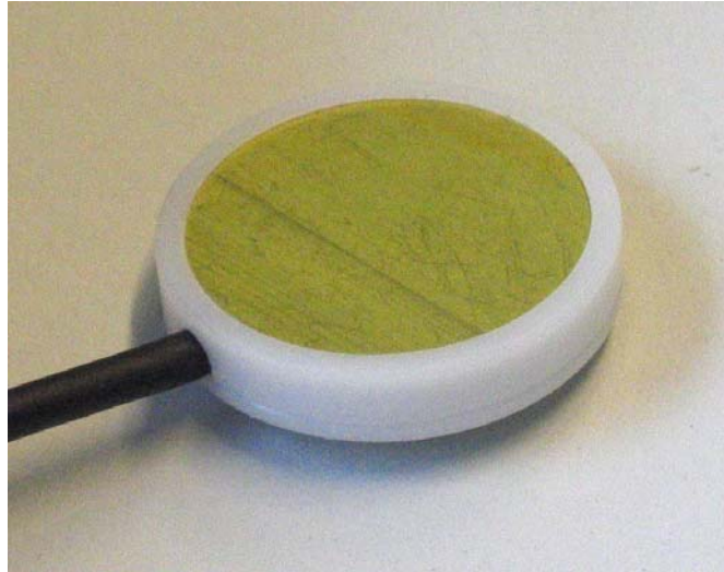
Abbildung 4-3: Mikrofon mit PVC / Messing-Oberschale
