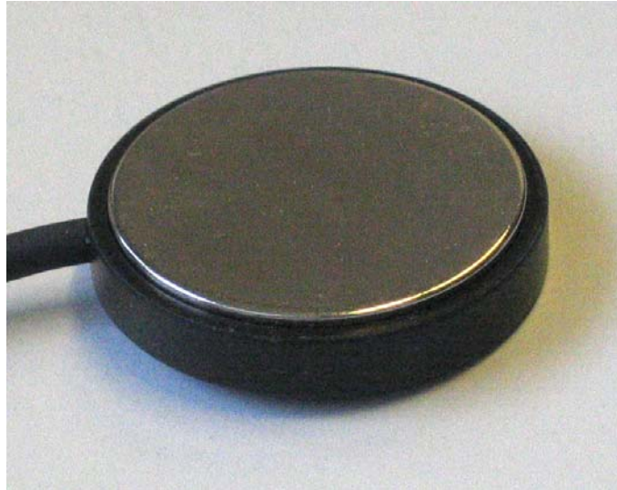
Abbildung 4-4: Modifiziertes Mikrofon mit PVC-Unterschale
