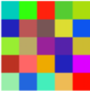
Abbildung 6.3: Beispiel zur Quantifizierung der Farbhomogenität: Im Ausgangsbild (links) werden sukzessiv zufällig ausgewählte Bildpixel vertauscht bis ein Durchmischungsgrad von 100% erreicht wird. Zu jedem der so entstandenen Bilder wird anschließend die Farbhomogenität gemessen (rechts).
