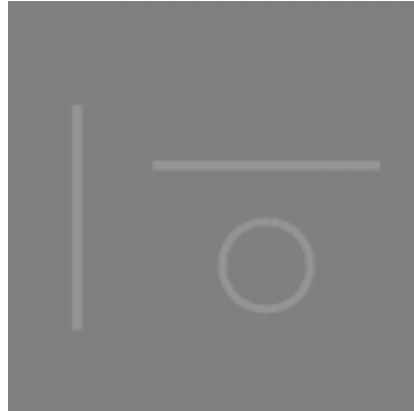
Abbildung 4.23: Testbild zur TDE-SIM : Neben den sichtbaren Strukturen sind im Grauwertbild weitere drei Strukturen enthalten, die sich nur durch eine Grauwertdifferenz von 1 vom Hintergrund abheben.
