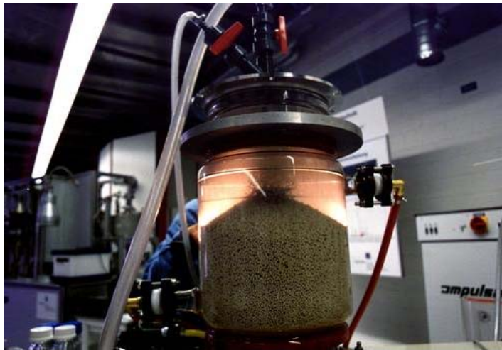
Abbildung 1.2: Anaerober Festbettreaktor im Labormaßstab (Fraunhofer Institut für Grenzflächen- und Bioverfahrenstechnik, aus [99])
