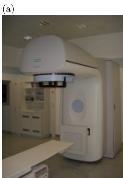
Abbildung 3.8: (a) Klinische Linearbeschleunigeranlage (b) Blick von vorne auf den Strahlerkopf mit Kollimator, der gegenüber dem Rest des Strahlerkopfs drehbar ist.
