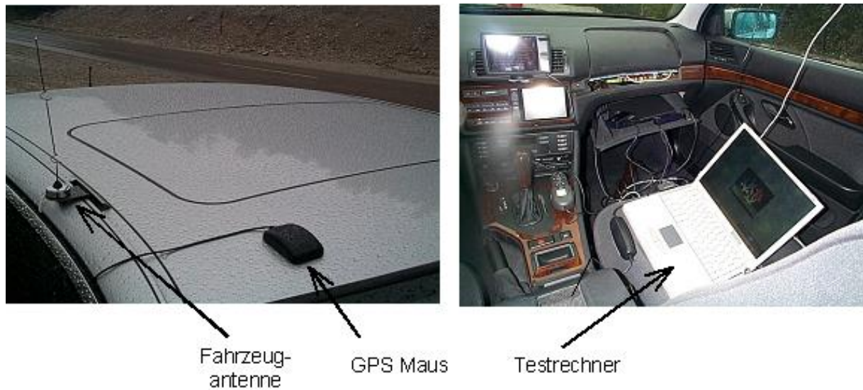
Abbildung 5.3: Testaufbau im Fahrzeug
