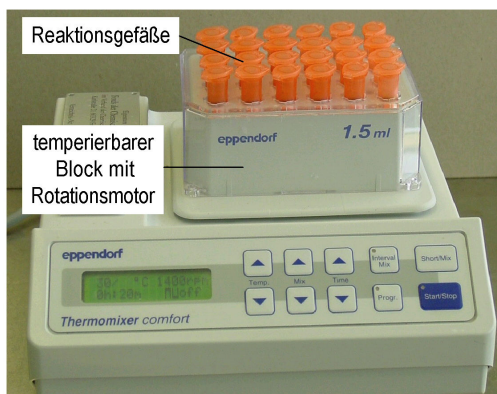
Abb. 4.6-1 Abbildung des geschüttelten Reaktionssystems im 400 \mu L-Maßstab
