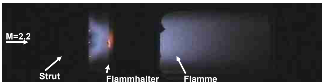
Abb. 5.34: Verlängerung der im Eigenleuchten sichtbaren Flamme
