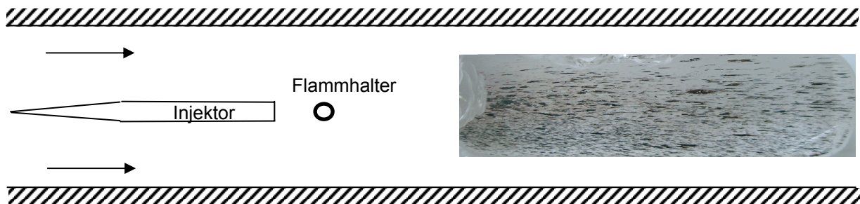
Abb. 5.7: Niederschlag des Flammhaltermaterials an einem Quarzglas der Brennkammer
