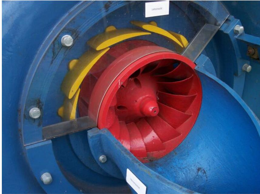
Abbildung 3.6: Typisches Francis Turbinenlaufrad mit Leitapparat (gelb)
