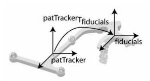
Abbildung 25: Sowohl für Navigated Control in der dentalen Implantologie als auch in FESS wird der an einer Bissschiene befestigte Patiententracker der Firma RoboDent GmbH verwendet. Die Transformation shaverTcpT<sub>fiducials</sub> zwischen dem Koordinatensystem des Trackers und der an der Bissschiene für die Patientenregistrierung angebrachten Titanmarken ist bekannt.
