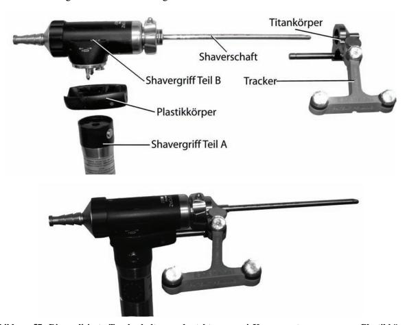
Abbildung 57: Die realisierte Trackerhalterung besteht aus zwei Komponenten: gegossener Plastikkörper und Titanhalterung. Diese beiden Komponenten können intraoperativ jederzeit vom Shaver abmontiert, und ohne zusätzliches Werkzeug wieder zusammengesetzt werden.
