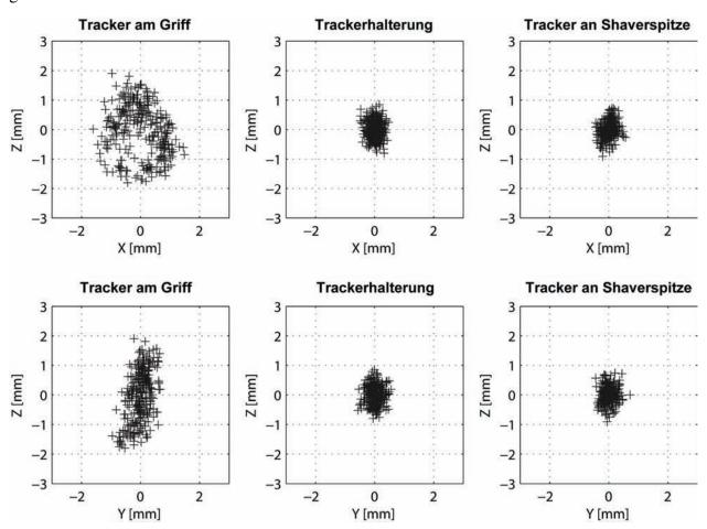
Abbildung 58: Bei der Wiederholung der Messung vom Kapitel 3.5.4 zeigt sich, dass die realisierte Trackerhalterung (in der Mitte dargestellt) eine ebenso hohe Genauigkeit bei der Bestimmung der Shaverspitzenposition wie eine starre Befestigung des Instrumententrackers am Shaverschaft ermöglicht. In den Abbildungen sind die relativen Abweichungen der gemessenen Positionen der Shaverspitze dargestellt, während die Shaverspitze festgehalten und der Griff ohne großen Kraftaufwand bewegt wurde.
