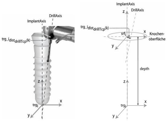
Abbildung 47: Eine geeignete Metrik für die Bewertung der Bohrerlage muss einen Abstand zwischen Bohrer und Implantatachse verwenden, der – wie bei  $^{trg\_i}dist_{dril|Tcp}(k)$  – nicht fortschrittsabhängig ist.
