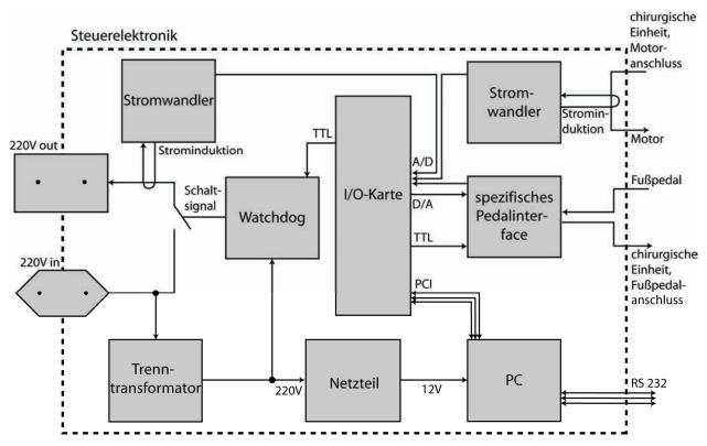
Abbildung 75: Die Hardware der Steuerelektronik beinhaltet einen PC für die Ausführung des Steuerprogramms, dass über die serielle Schnittstelle mit dem Navigationssystem und über die I/O-Karte mit den anderen Hardwarekomponenten kommuniziert. Die Stromwandler ermöglichen die Überwachung des Shavermotors und der chirurgischen Einheit, der Watchdog unterbricht die Spannungsversorgung der chirurgischen Einheit im Fehlerfall. Das spezifische Pedalinterface schleift die Signale des Fußpedals durch.
