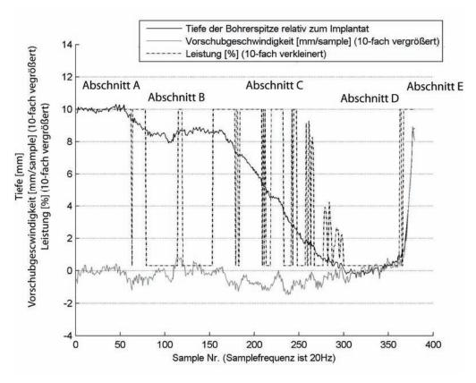
Abbildung 45: Bei einer Beachtung des Bohrvorschubs bei Navigated Control wird der Bohrer durch das Abschalten bei zu hoher Vorschubgeschwindigkeit abgebremst, was zu einem besseren Erreichen der Zieltiefe führt. Im Abschnitt C wird beim Bohren in die Tiefe im Gegensatz zur Abbildung 44 der Bohrer abgebremst, wenn er eine zu hohe Vorschubgeschwindigkeit erreicht, was zu häufigem Abschalten führt. Die anderen Abschnitte A, B, D und E sind mit den Abschnitten in Abbildung 44 identisch.
