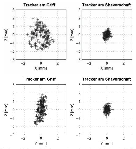
Abbildung 36: Die Genauigkeit der Befestigungsvariante A (rechts) ist höher als die Ungenauigkeit der Befestigungsvariante B (links). In den Abbildungen sind die relativen Abweichungen der 301 gemessenen Positionen der Shaverspitze, während die Shaverspitze festgehalten und der Griff ohne großen Kraftaufwand bewegt wurde, dargestellt.
