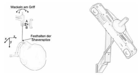
Abbildung 35: Bei der Messung werden die Genauigkeiten der Befestigungsvariante A bzw. B verglichen. Durch die geringe Steifigkeit der Befestigung zwischen Shaverschaft und Shavergriff wird erwartet, dass die Variante A zu hoher Ungenauigkeit bei der Bestimmung der Position der Shaverspitze durch das Positionsmesssystem führt.
