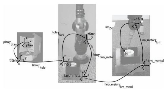
Abbildung 84: Für die Vermessung der abgetragenen Oberfläche im Koordinatensystem der Planung muss in einem Zwischenschritt die Position der Titanmarker mit dem FaroArm vermessen werden.
