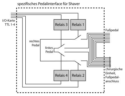
Abbildung 76: Das spezifische Pedalinterface ist ein Modul, das für die Anpassung an ein konkretes Fußpedal in der Steuerelektronik verwendet wird. In der hier dargestellten Realisierung für einen Shaver kann das Signal des linken und des rechten Pedals abgeschaltet werden, es sind jeweils zwei Relais (Redundanz) in Reihe geschaltet.
