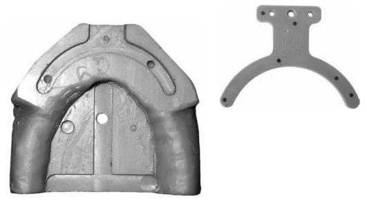
Abbildung 78: Links ist ein aus einem Schnellgießharz hergestellter Phantom dargestellt, der rechts dargestellte Navigationsbogen mit 6 Titanmarkern, der für die bissschienenbasierte Patientenregistrierung an einer Bissschiene befestigt wird, kann direkt in der vorgesehenen Aussparung im Phantomkiefer befestigt werden.
