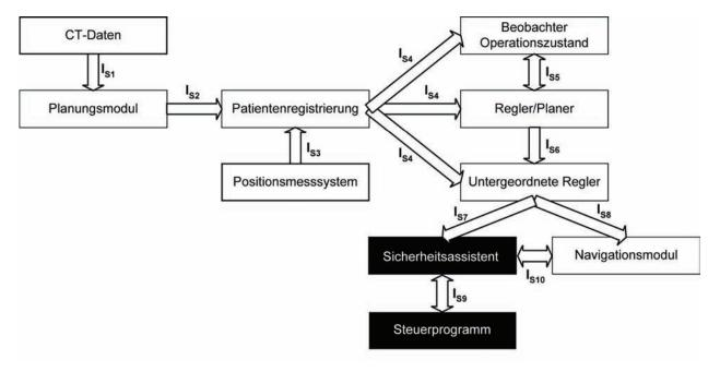
Abbildung 73: Die in diesem Kapitel beschriebenen Softwarekomponenten für die Sicherheitsarchitektur sind schwarz dargestellt.
