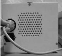
Abbildung 74: Links: Das vordere Bedienfeld der Steuerelektronik (hier in der Ausführung für FESS) ermöglicht den Anschluss an die chirurgische Einheit, an das Fußpedal, an das Navigationssystem und an das Instrument, Rechts: Auf der Rückseite wird die Spannungsversorgung der chirurgischen Einheit angeschlossen.
