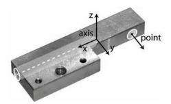
Abbildung 61: Der Kalibrier- und Registrierkörper wurde für den Patiententracker der Fa. RoboDent GmbH optimiert. Für die Kalibrierung wird die Sackbohrung (links im Kalibrierkörper zu sehen), für die Instrumentenregistrierung die Mulde (rechts im Kalibrierkörper zu sehen) verwendet.
