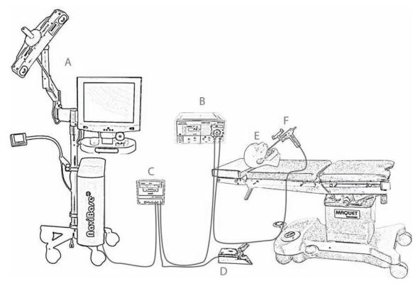
Abbildung 22: Die Hardwarekomponenten für Navigated Control sind hier exemplarisch für die Funktionale Endoskopische Sinuschirurgie dargestellt: A – Navigationssystem mit Positionsmesssystem, B – chirurgische Einheit, C – Steuerelektronik, D – Fußpedal, E – Patient, F – Shaver (Instrument).
