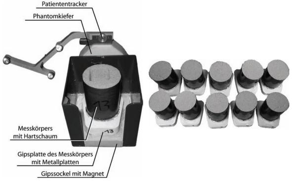
Abbildung 82: In das Phantom für die Bestimmung der Genauigkeit des Abtrags mit einem Shaver können einzelne Messkörper reproduzierbar eingesetzt werden. Die Messkörper enthalten Hartschaum, der durch den Shaver abgetragen, und anschließend vermessen wird.
