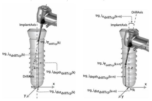
Abbildung 46: Eine fortschrittsabhängige Metrik für die Bohrerfreigabe kann dazu führen, dass nach dem initial korrekten Positionieren und Ausrichten des Bohrers dieser im Knochen abgeschaltet wird, weil sich der Abstand zwischen Bohrerspitze und Implantatachse durch den initialen Winkelfehler vergrößert hat.
