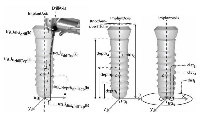
Abbildung 49: Für die Erkennung der Zustandsübergänge durch den Beobachter wird die Position des Bohrers bestimmt (links), und mit auf ein Implantat bezogenen maximalen Abweichungen bewertet (mitte und rechts).
