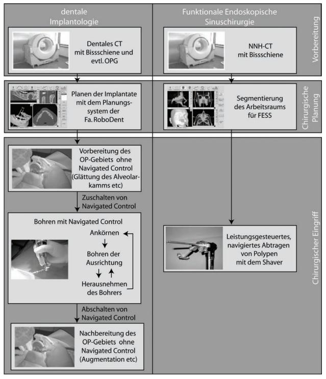
Abbildung 21: Der Benutzungsablauf von Navigated Control in der dentalen Implantologie (links) ist komplexer als der für FESS (rechts) und umfasst mehr intraoperative Behandlungsschritte.
