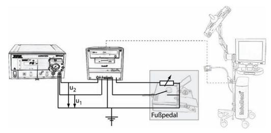
Abbildung 31: Die Steuerelektronik liest die am Fußpedal durch den Arzt eingestellte Instrumentenleistung ein, und verringert diese in Abhängigkeit von dem Signal des Navigationssystems.
