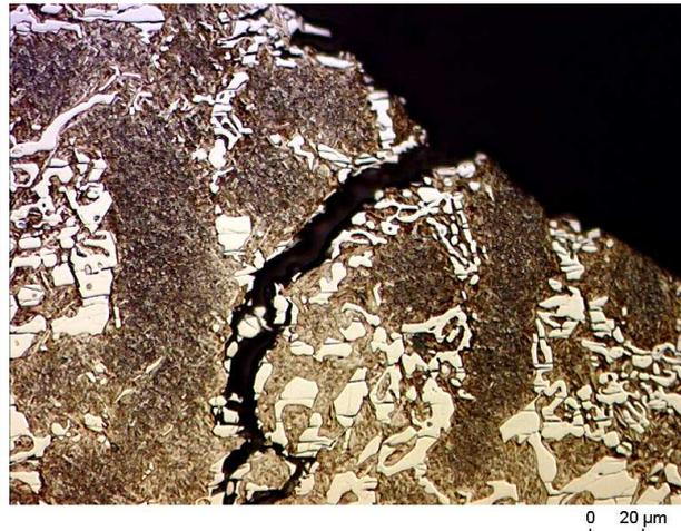
(d) Axiale Probenlage, Detail aus (b), Nital
