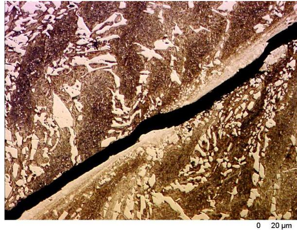
(c) Lokalisierung der Verformung in einem Scherband, Material A, Nital.
