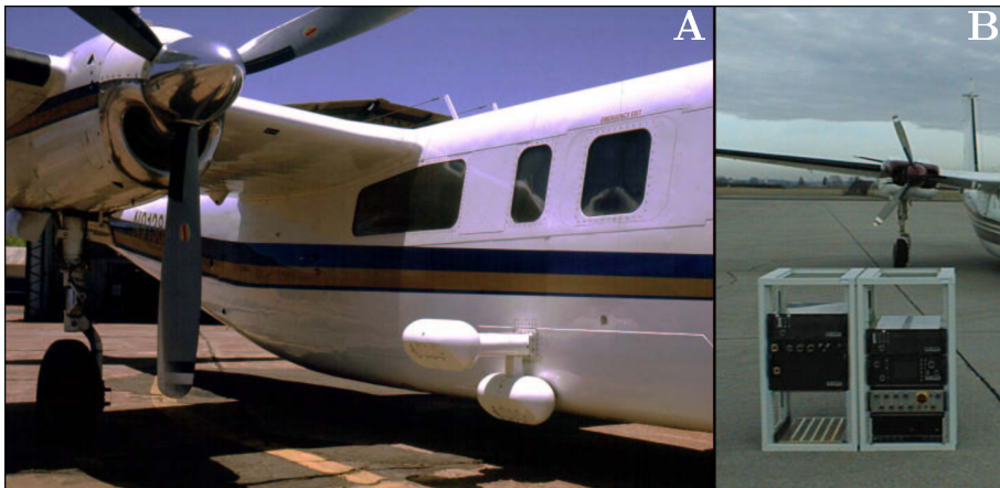
Abbildung 2.10: Flugzeuggestützter SAR-Sensor der Firma AeroSensing (X- oder P-Band, interferometrisch). A: Zwei der drei SAR-Antennen; die dritte ist Backbordseitig angebracht. B: Die aus dem Flugzeuggestell ausgebaute Steuer- und Aufnahmeelektronik.
