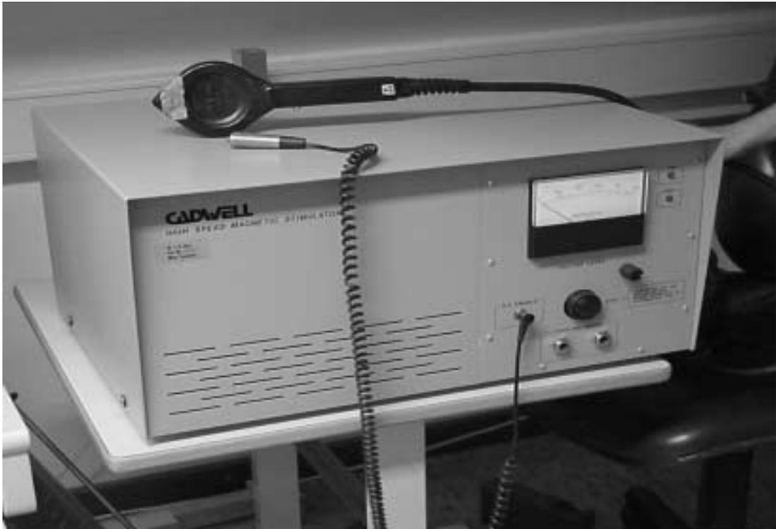
**Abbildung 2: Transkranieller Magnetstimulator zur Applikation rhythmischer Reizserien der ersten Generation mit Rundspule (Firma Cadwell, USA)**
