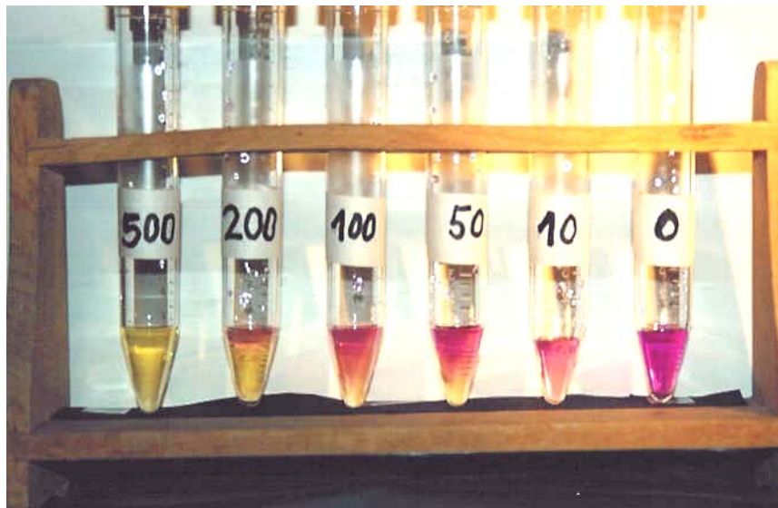
Abbildung 23: Clodronat in den Mengen 0 \mu\text{l} , 10 \mu\text{l} , 50 \mu\text{l} , 100 \mu\text{l} und 500 \mu\text{l} vermischt mit Thorium-EDTA-Xylenolorangelösung
