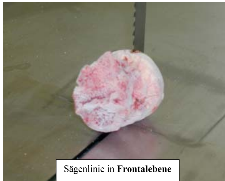
Abbildung 10: Sägen des Hüftkopfs in der Frontalebene mit einer Bandsäge ( Fa. Bycerba)
