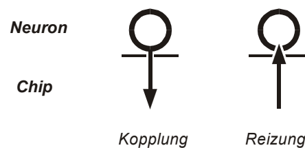
Abbildung 1.2: Detektion (Kopplung an Feldeffekttransistoren) und Stimulation (Reizung mit Reizspots) als abstrakte Signalübertragung über die Neuro-Chip-Schnittstelle.
