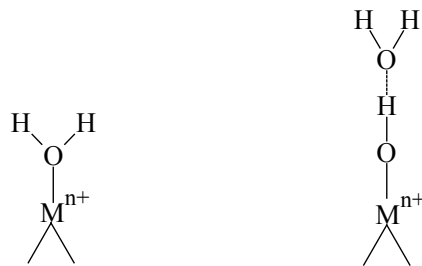
Abb. 2-10 molekulare Adsorption von H_2O auf Metalloxiden. Als Adsorptionsplatz dient eine Lewis-saures Zentrum (LS), d.h. ein Metallion.
