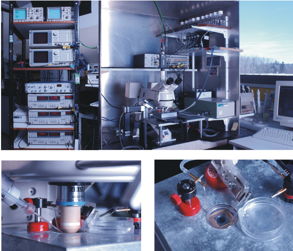
Abbildung 3.2: Photos vom Messaufbau. Rechts oben: In der Mitte befindet sich der Messchip unter dem Mikroskop. Links davon ist der Mikromanipulator angebracht, mit dem die Zellen über eine Pipette kontaktiert werden. Rechts befindet sich der FET-Verstärker, im oberen Teil ist der Ausgang der Messkarte sowie das Perfusionssystem mit 10 verschiedenen Lösungsbehältern zu sehen. Links oben: In der Mitte befindet sich der Patch-Clamp-Verstärker, darunter und darüber die Lock-In-Verstärker. Links und rechts unten: Der Messchip mit der Patchpipette, dem Zu- und Abfluß des Perfusionssystems sowie der Salzbrücke und Badelektrode.
