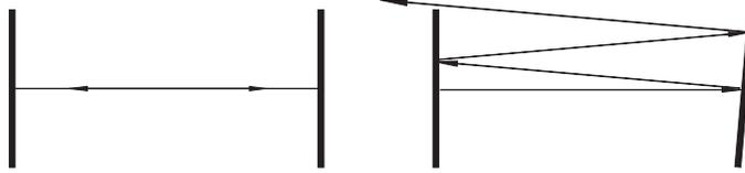
Abbildung 3.17: Resonator mit ebenen Spiegelflächen. Ein Lichtstrahl auf der optischen Achse bleibt im Resonator, falls die Spiegel perfekt parallel sind. Bei leichter Verkippung eines der beiden Spiegel verlässt er den Resonator.
