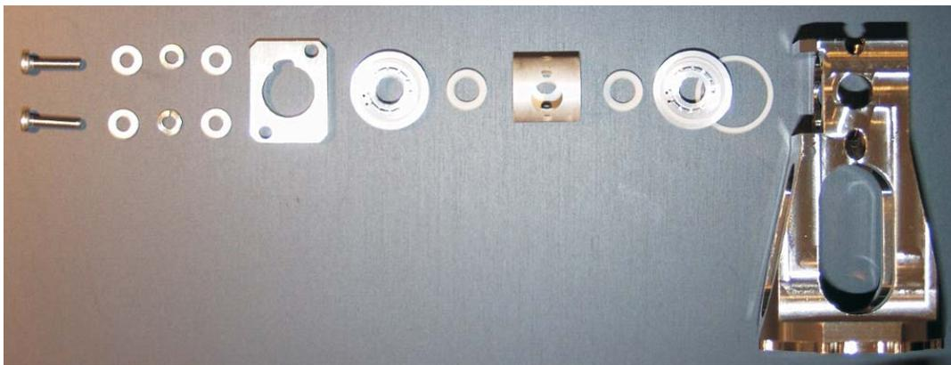
Abbildung 3.19: Foto des Edelstahlhalters und der Einzelteile der Spiegelhalterung kurz vor dem Einbau.
