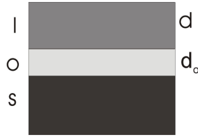
Abbildung 2.2: Ein Film l der Dicke d auf einem Substrat s , dazwischen befindet sich eine Oxidschicht o der Dicke d_o .
