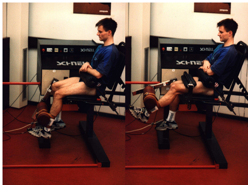
Abb. 6-3: Der statisch-exzentrische Test am Drehmomentmessstuhl. Ausgangsstellungen: Links: Messung der Kniegelenkstreckmuskulatur. Rechts: Messung der Kniegelenkbeugemuskulatur.
