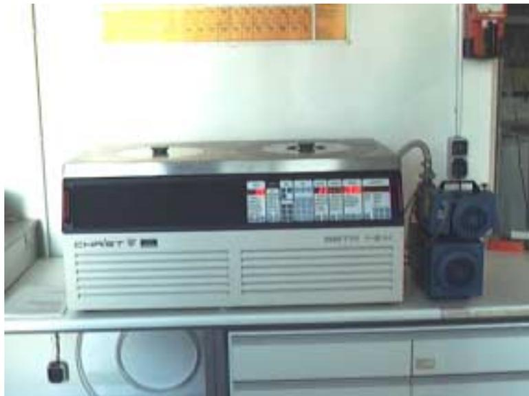
**Abb. 34:** computergesteuerte Gefriertrocknungsanlage BETA 1-8K der Fa. Christ
