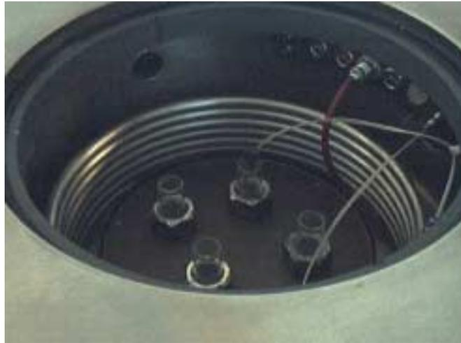
**Abb. 35:** Eiskondensatorraum des Gefriertrockners, beheizbare Stellfläche, Kryogefäße und Produktmessfühler
