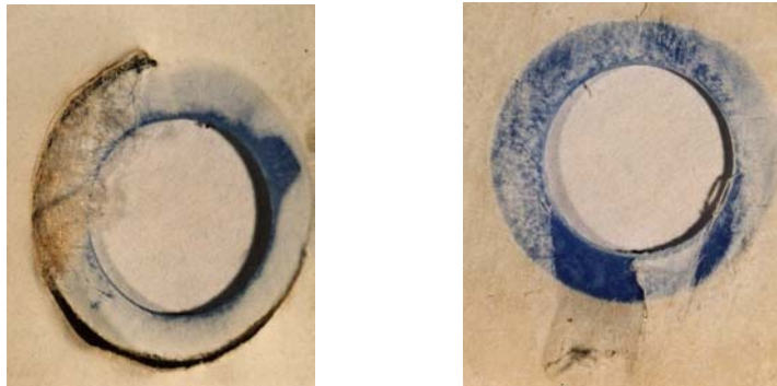
Bild 5.3. Abscheren der Membran infolge der Oszillationsbewegung (links) und Abrieb der Membran durch Spelzensplitter in der Maische (rechts)
