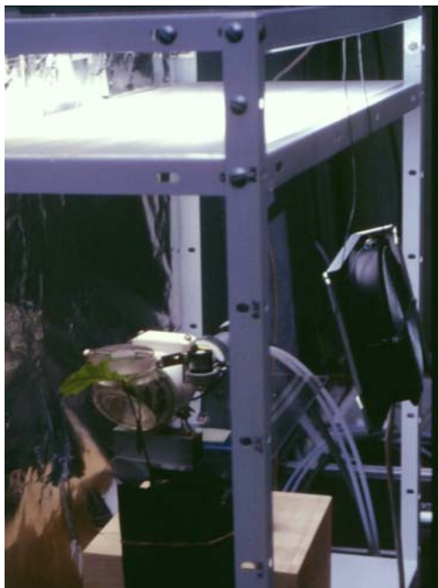
Abbildung 2.7 (A-B). Gaswechsellung an einem Eichenblatt mit dem Porometer. A, Messaufbau. B, Küvette des Porometers mit eingespanntem Eichenblatt.
