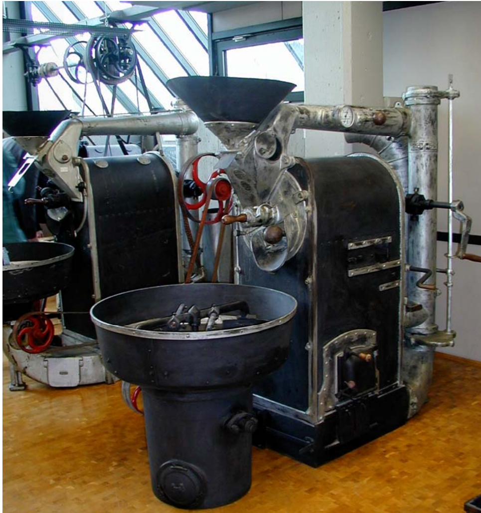
Abbildung 9: Trommelröster SA mit angebautem Kühlsieb. Baujahr ca. 1880. Hersteller: Emmericher Maschinenfabrik und Eisengießerei GmbH. Der Röster wurde mit Koks beheizt. Er fasste Chargen von 15 kg. Zur Bewegung der Rösttrommel und des Rührwerks im Kühlsieb besitzt dieser Röster einen Anschluss für Kraftantrieb (rote Räder).
