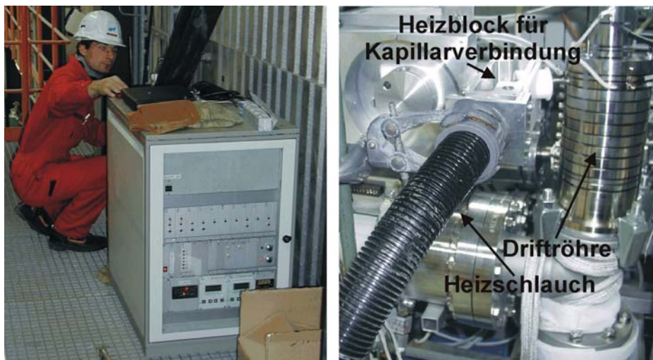
Abbildung 46: Photographie des PTR-Massenspektrometers bei einem Einsatz zur Prozessanalytik an einer Hausmüllverbrennungsanlage und Detailaufnahme der Anschlußregion des neuen Probeneinlasssystems für heiße Prozessgase.
