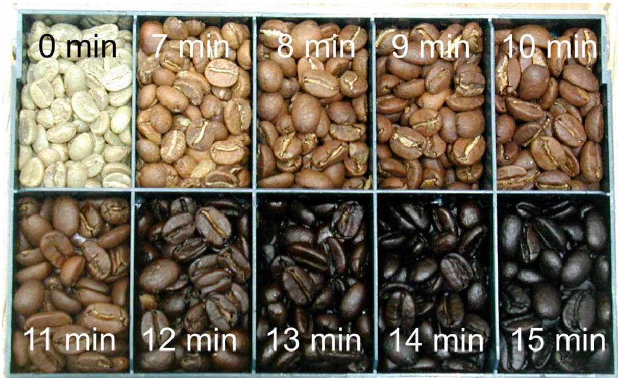
Abbildung 80: Typische Röstergebnisse eines BRZ2 Proben-Trommelrösters nach verschieden langer Röstdauer bei einer Einfülltemperatur von 200 °C.
