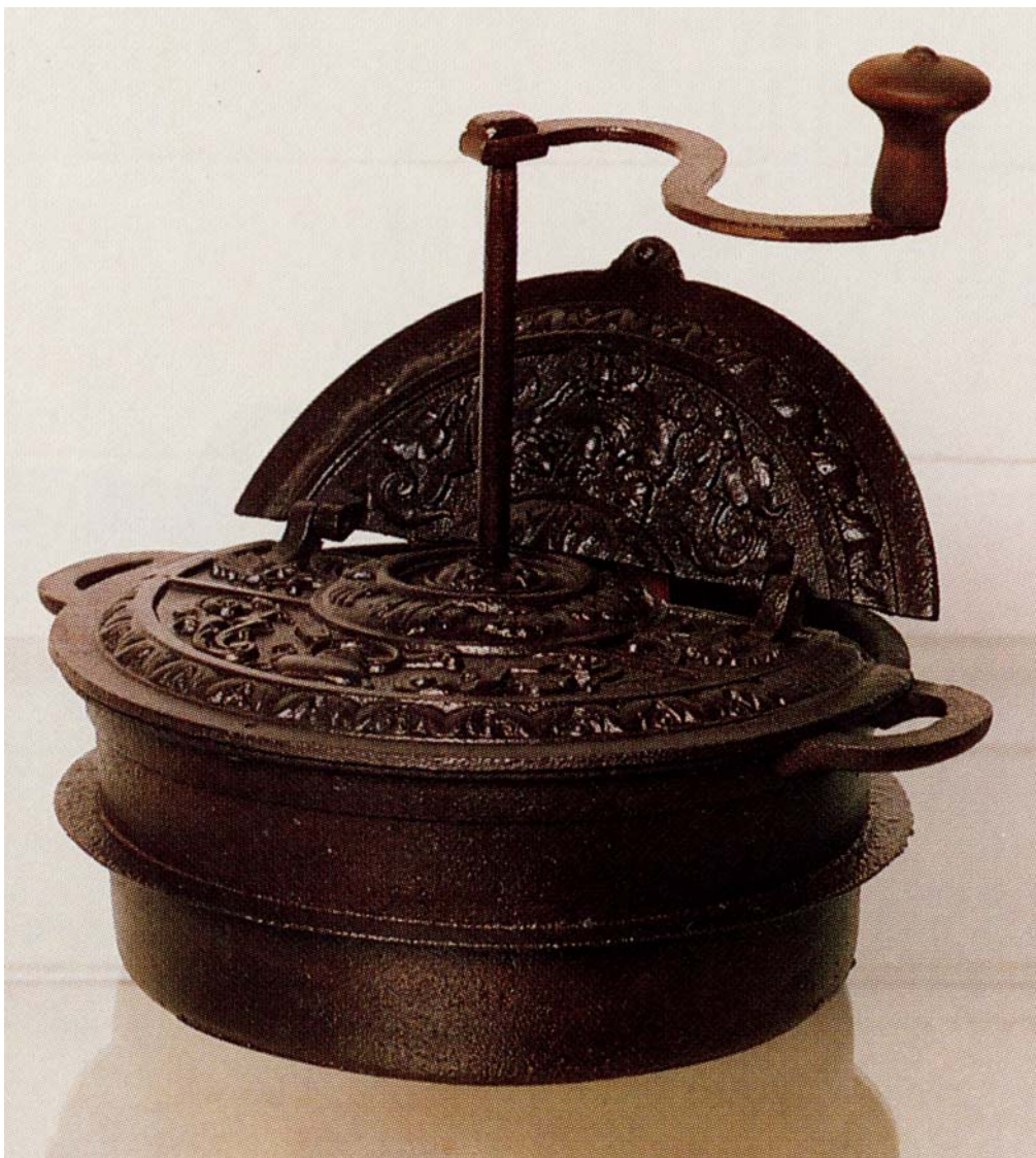
Abbildung 7: Geschlossene Röstpfanne mit Rührer, hergestellt um 1900. Die gusseiserne Röstpfanne war zum Gebrauch auf dem Kochherd vorgesehen und fasste eine Rohkaffeemenge von ca. 1000 g. Aus [24].
