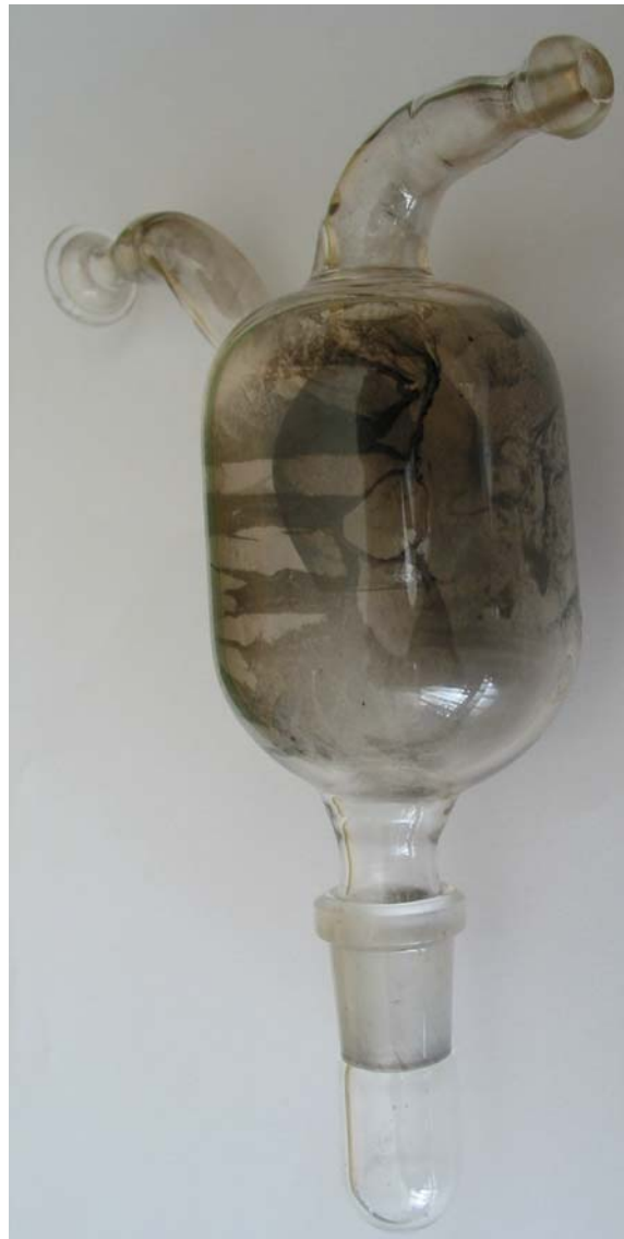
Abbildung 36: erste Version eines Miniaturzyklons mit inerten Oberflächen. Die Rückstände von Brenngasen deuten den Strömungsverlauf im Zyklon an. Details siehe Text.
