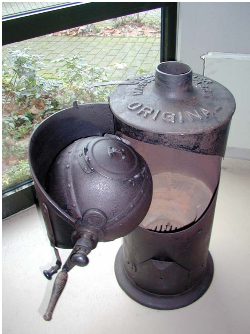
Abbildung 8: Kugelröster Typ AZ von der Emmericher Maschinenfabrik. Der Kugeldurchmesser beträgt 310 mm. Der Röster wurde nach 1902 gebaut. Die Kugel wurde per Hand gedreht, der Ofen mit Koks oder Kohle beheizt. Die Chargengröße beträgt 5 kg.
