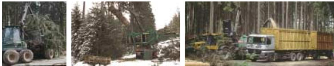
Forwarder, Bündelaggregat auf LKW, Hacker, LKW mit Wechselcontainer
