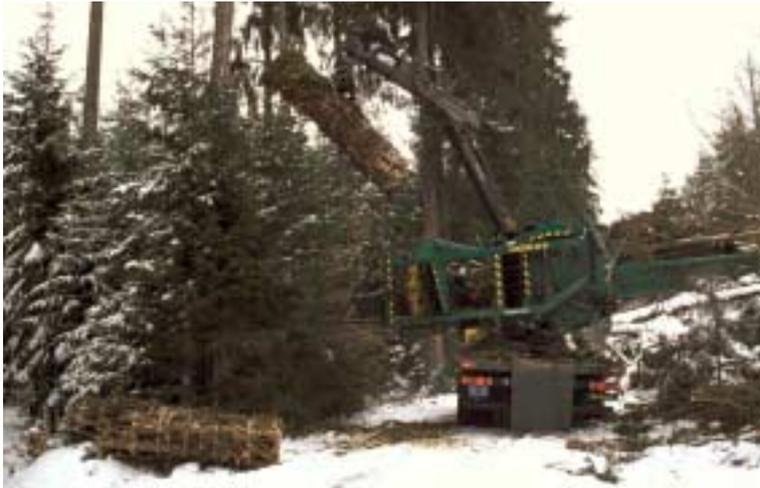
Abbildung 41: Bündelmaschine Fiberpack beim Einsatz in Ebersberg
