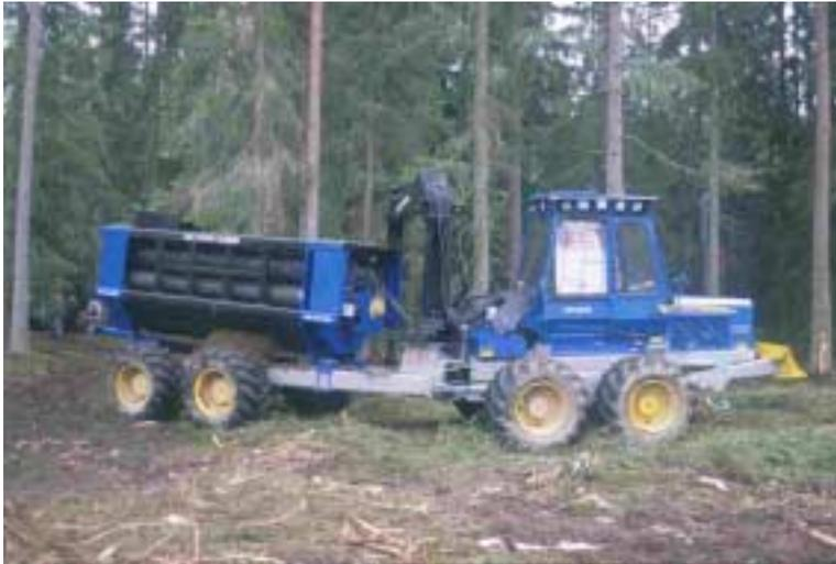
Abbildung 63: Bündelaggregat Wood Pac auf Forwarder
