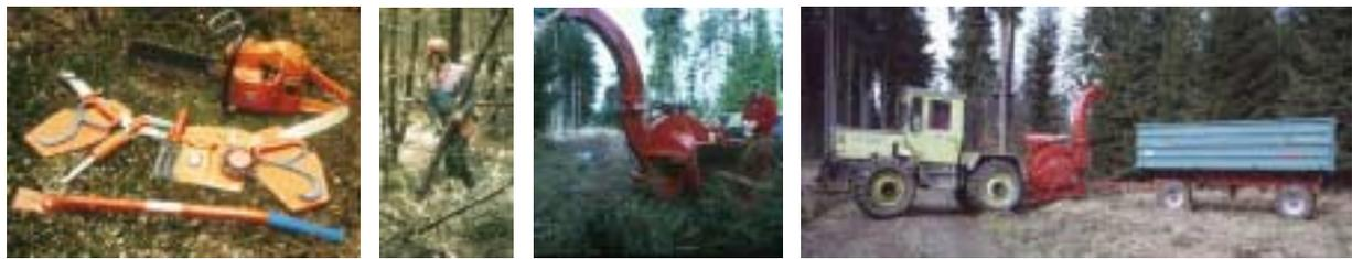
Persönliche Schutzausrüstung, Motorsäge, Fällheber, Packzangen, Schlepper, Anbauhacker, zwei Anhänger für Hackschnitzeltransport
