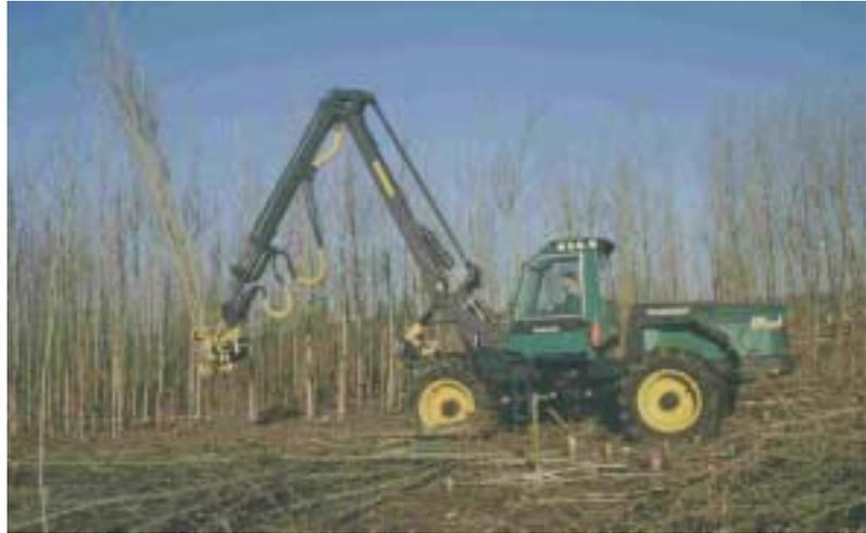
Abbildung 60: Harvester mit Mehrfachfällkopf bei der Ernte eines Energiewaldes
