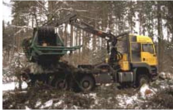
Abbildung 62: Fiberpac auf LKW montiert
