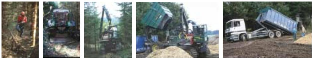
Persönliche Schutzausrüstung, Fällheber, Motorsäge, Schlepper mit Funkseilwinde, Aufbauhacker auf Forwarder, LKW mit Wechselcontainer
