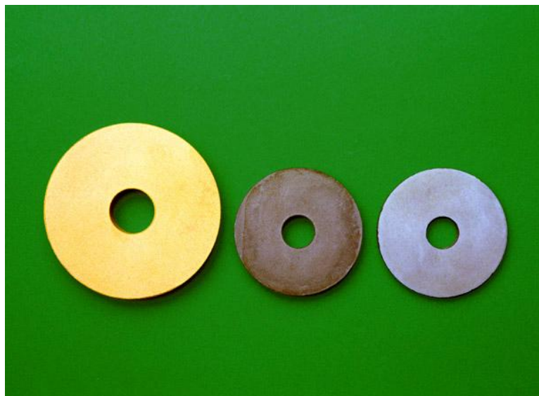
Abb. 132: Ringförmiges Formteil auf Basis des Holzwerkstoffsystems A2: Grünkörper, C-Templat, Keramik
