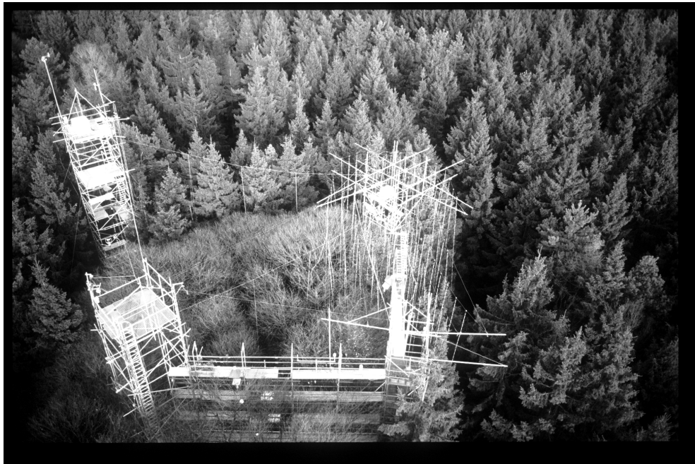
Abbildung 1: Aufnahme der Intensivmessfläche im Kranzberger Forst vom Kran. Die Buchengruppe (innerhalb der Gerüsttürme) ist von den Fichten umschlossen. Drei der vier Türme sind in vier Ebenen mit einem Gerüst verbunden.
