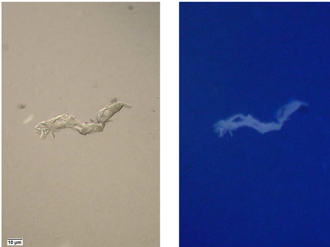
Abbildung 74: Faser im Durchlichtverfahren (links), mit Fluoreszenz (rechts)
