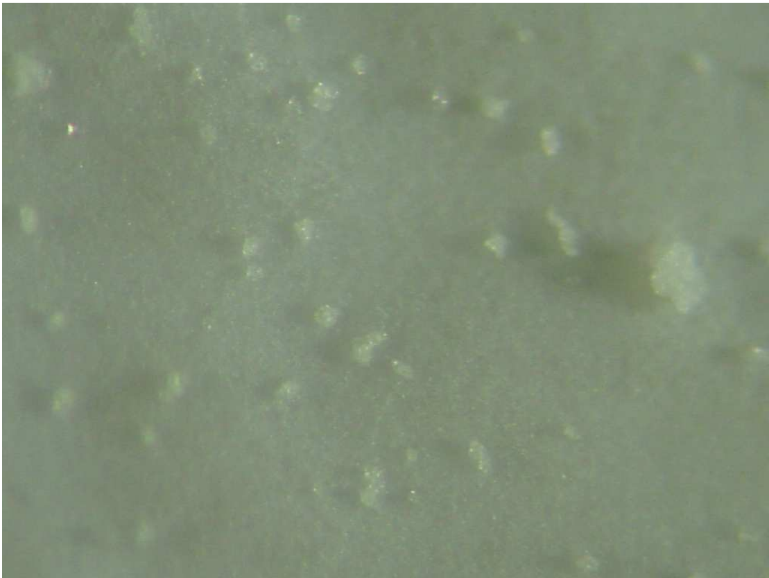
Abbildung 68: PVPP-Partikeln ungefärbt, aufgenommen mit einem Stereomikroskop
