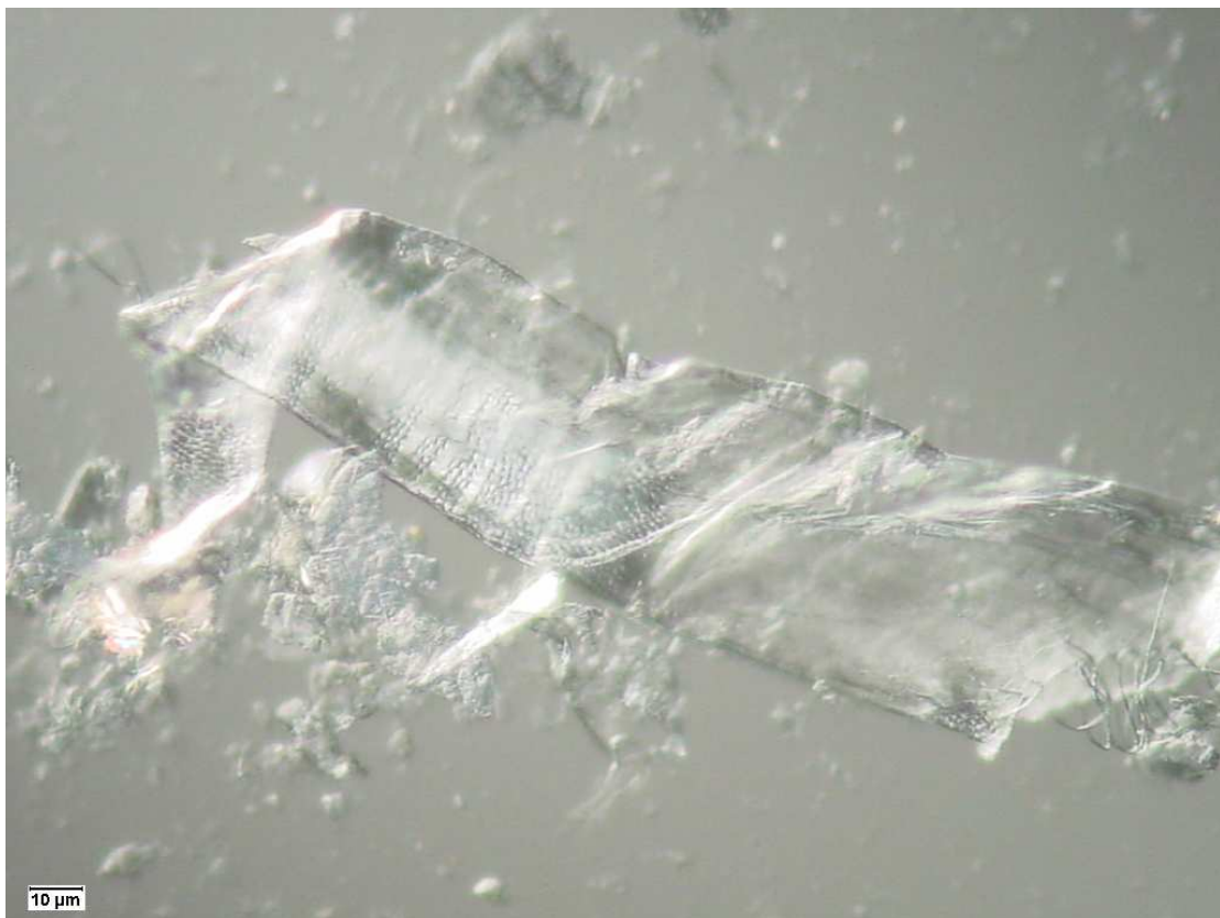
Abbildung 75: Intakte Faser aus einem Etikett
