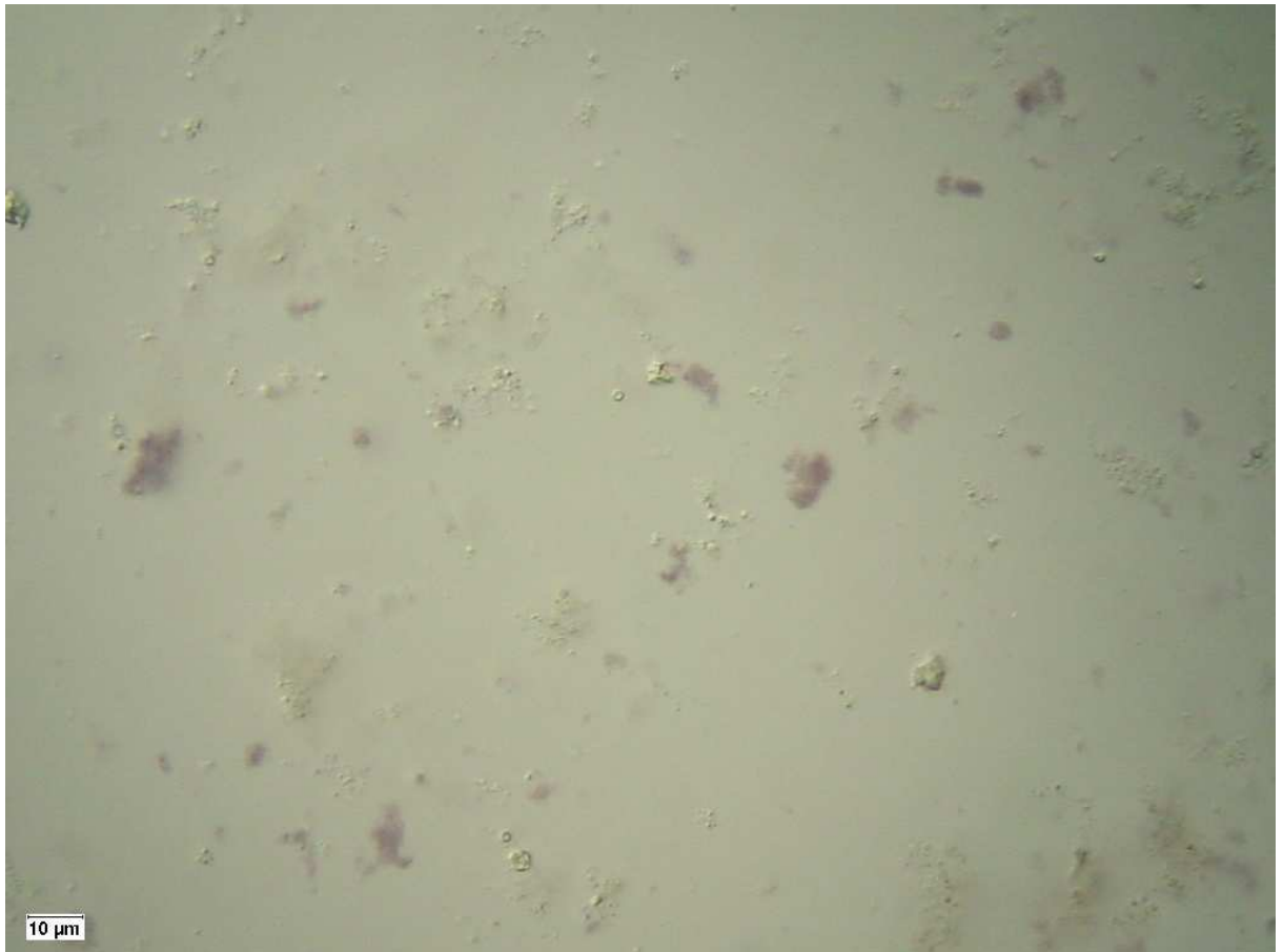
Abbildung 25: Heißtrub, gefärbt mit Jod
