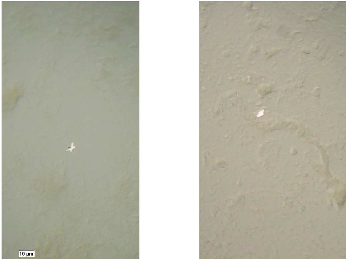
Abbildung 53: Kalziumoxalatmonohydratkristall in Sternform (links), Kalziumoxalatmonohydratkristall in Rechteckform (rechts)
