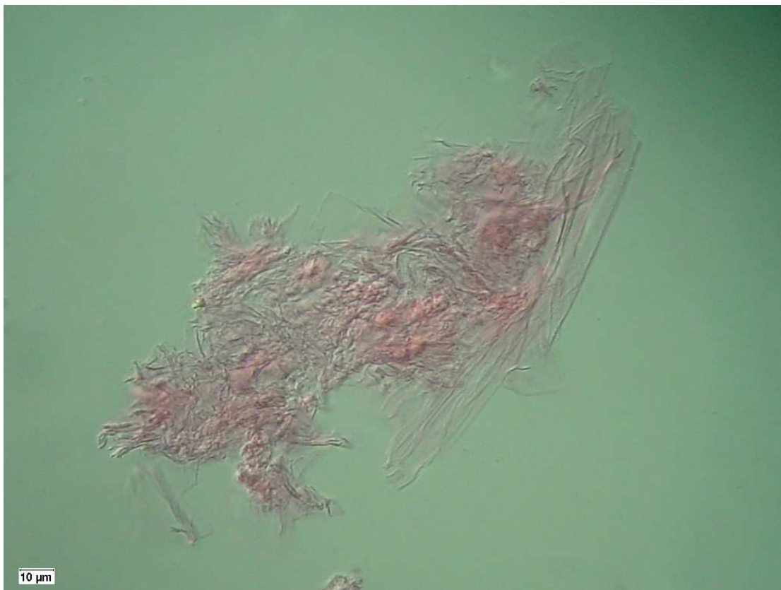
Abbildung 40: Eiweißpartikel gefärbt mit Eosin Yellow
