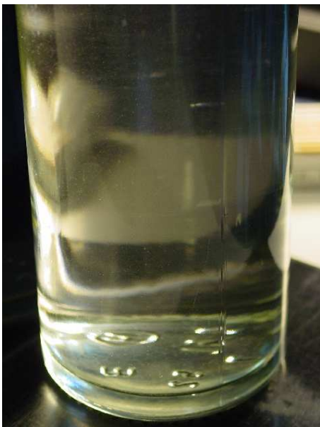
Abbildung 84 (links): Klarsichtflasche versetzt mit 4 mg/l Kieselgur in dest. Wasser (Bodensatz und weiße Partikeln in Schweben)
