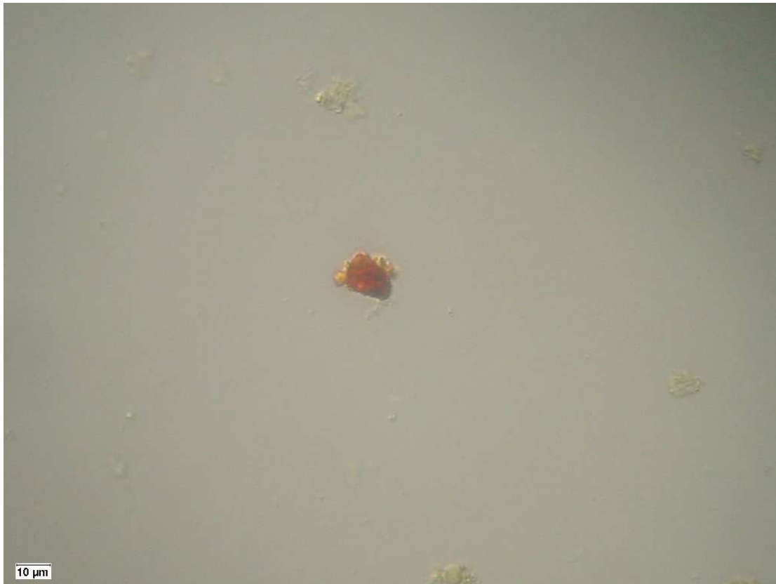
Abbildung 71: Kleines PVPP-Teilchen, gefärbt mit Jod
