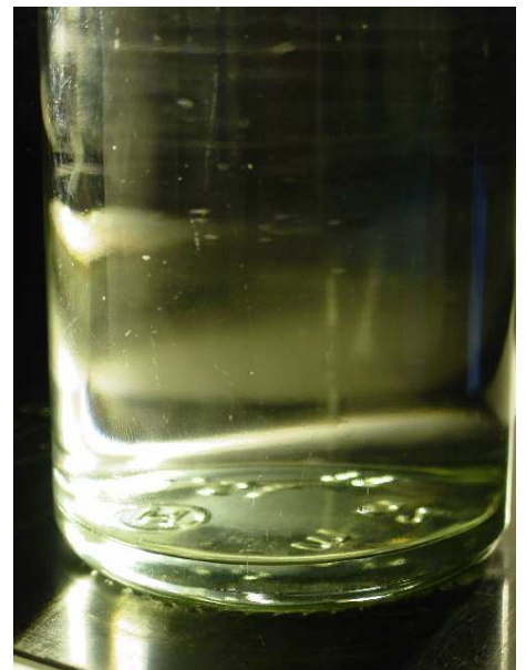
Abbildung 84 (links): Klarsichtflasche versetzt mit 4 mg/l Kieselgur in dest. Wasser (Bodensatz und weiße Partikeln in Schweben)
