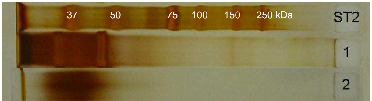
Abbildung 35: Molekülgrößenverteilung eines Hefebieres (Probe 1) im Vergleich zu einem nicht trüben Bier (Probe 2)
