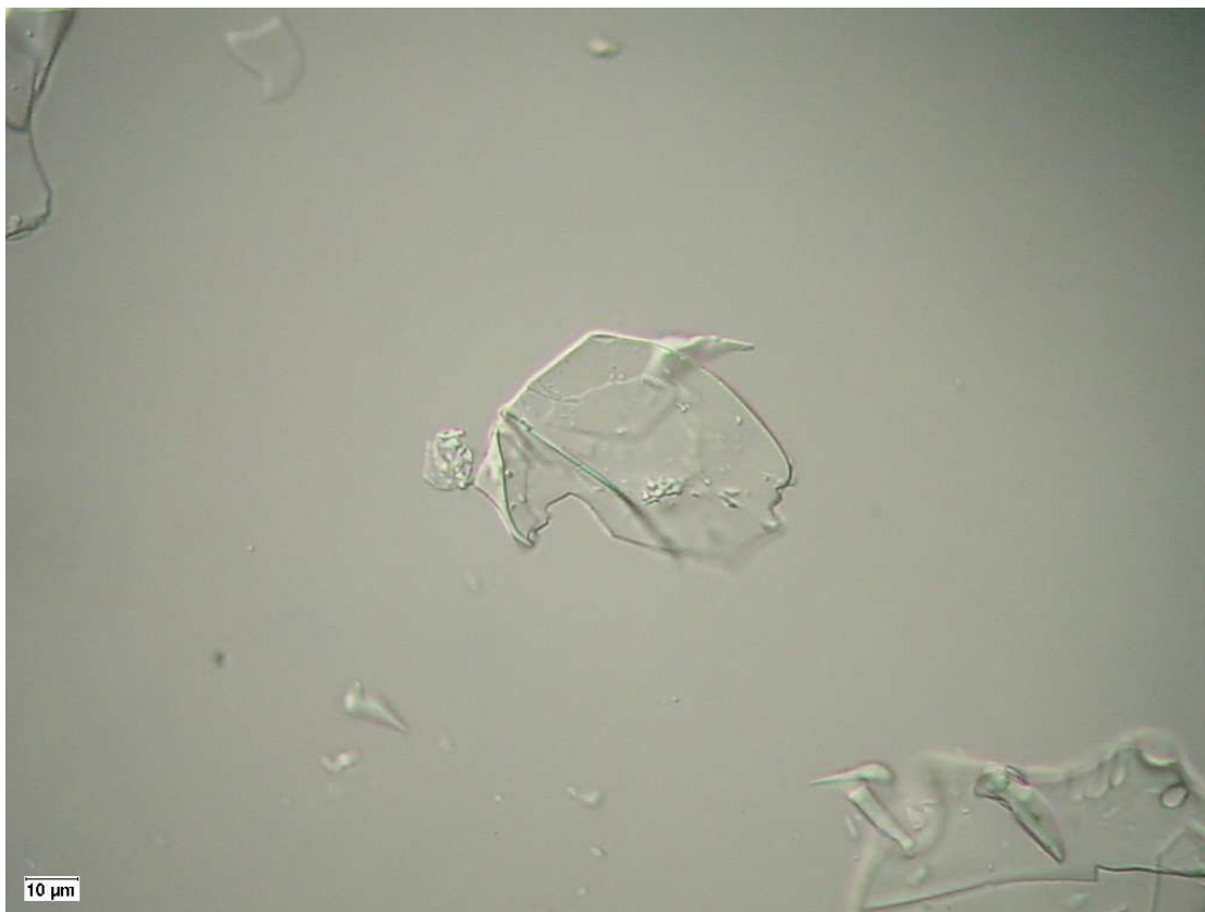
Abbildung 65: Perliteteilchen, durchzogen mit der charakteristischen Ader
