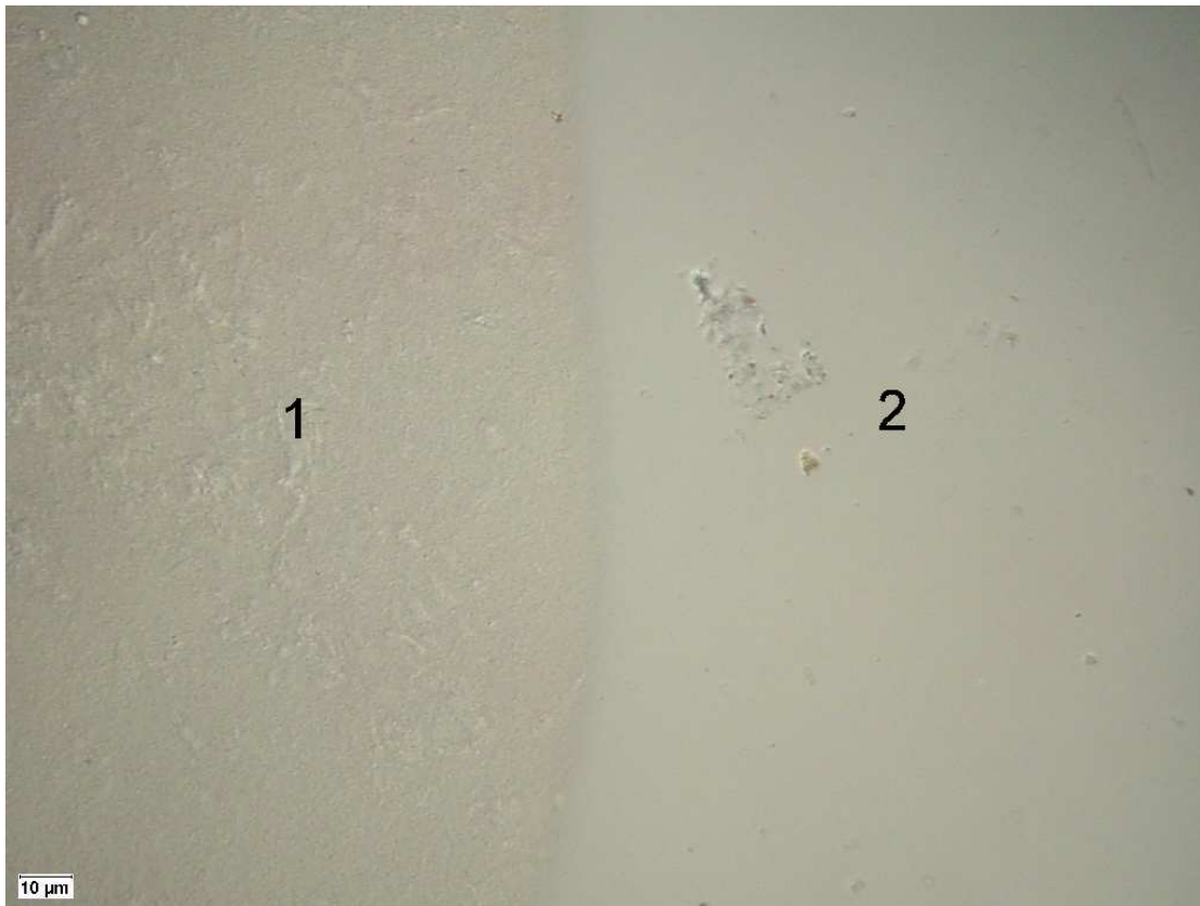
Abbildung 39: Eiweißpartikeln (1) durch KOH aufgelöst (2)
