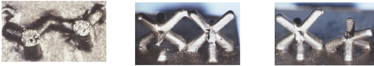
Abb. 4.4.1: Foto des Bruchverhaltens vernetzter Tripoden der Reihe 4a, Bruch im Zentrum (links); Bestehenbleiben der Verknüpfung mit Bruch der kurzen Stege mit Grundkörperkontakt (Mitte); links Bruch kurzer Steg mit Grundkörperkontakt, rechts Bruch des langen Steges im Zentrum (rechts)
