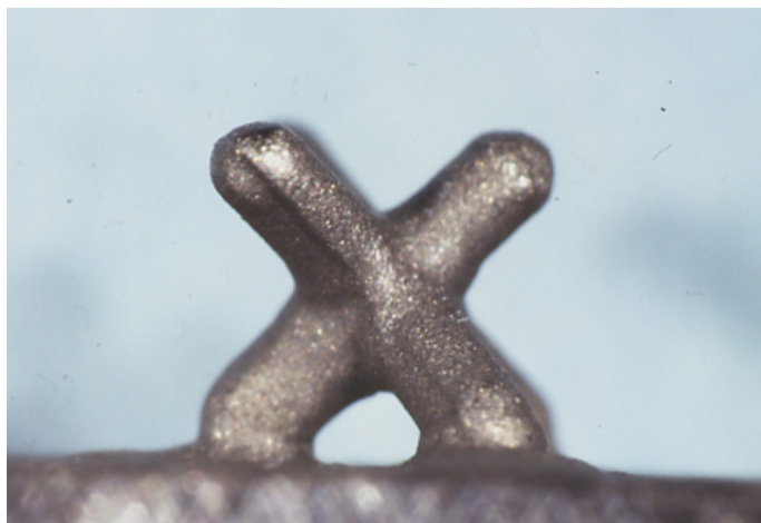
Abb. 3.1.2: Foto (links) und Skizze (rechts) der Geometrie der Tripode bei Drehung um 90 Grad mit den Winkeln \alpha und \beta zwischen dem Grundkörper und dem langen bzw. dem kurzen Steg
