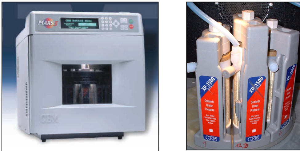
Abbildung 3.21: Mikrowellenaufschlusssystem Mars5 (links) und XP1500plus-Reaktionsgefäße (rechts). Das mittlere Reaktionsgefäß ist der Referenz-Hochdruckbehälter mit angeschlossenem Drucksensor.
