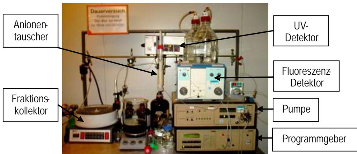
Abbildung 4.9: FPLC-Apparatur
