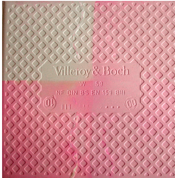
Abbildung 102: Mit Titandioxid behandelte Fliese nach einwöchiger Wasserlagerung und anschließender Applikation von RB und einstündiger Bestrahlung.
