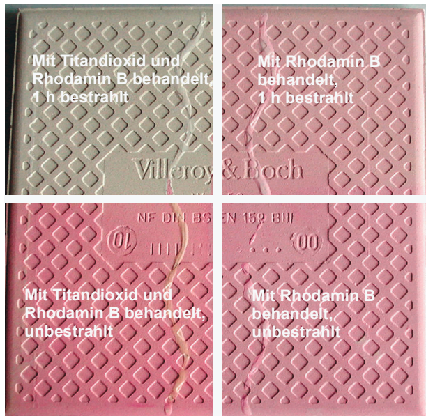
Abbildung 101: Mit RB und Titandioxid-Sol präparierte Fliese nach einer Bestrahlungsdauer von einer Stunde.
