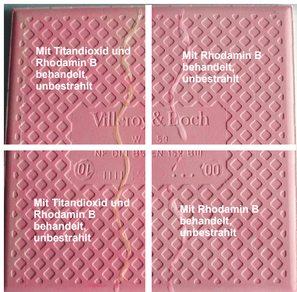
Abbildung 100: Mit \text{TiO}_2 /RB (links) bzw. nur mit RB (rechts) präparierte Fliesenrückseite.
