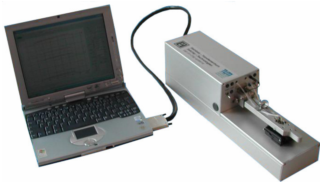
Abbildung 2.2: IMOLA-Messgerät mit PCMCIA-Card zur Datenübertragung auf einen Computer (Quelle: Heinz Nixdorf-Lehrstuhl für Medizinische Elektronik der TUM).
