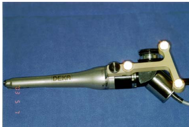
Abb. 41: Handstück des Er:YAG-Lasers (Smart 2940D, Fa. DEKA-DLS, I-Firenze) und Prismenhalter.
