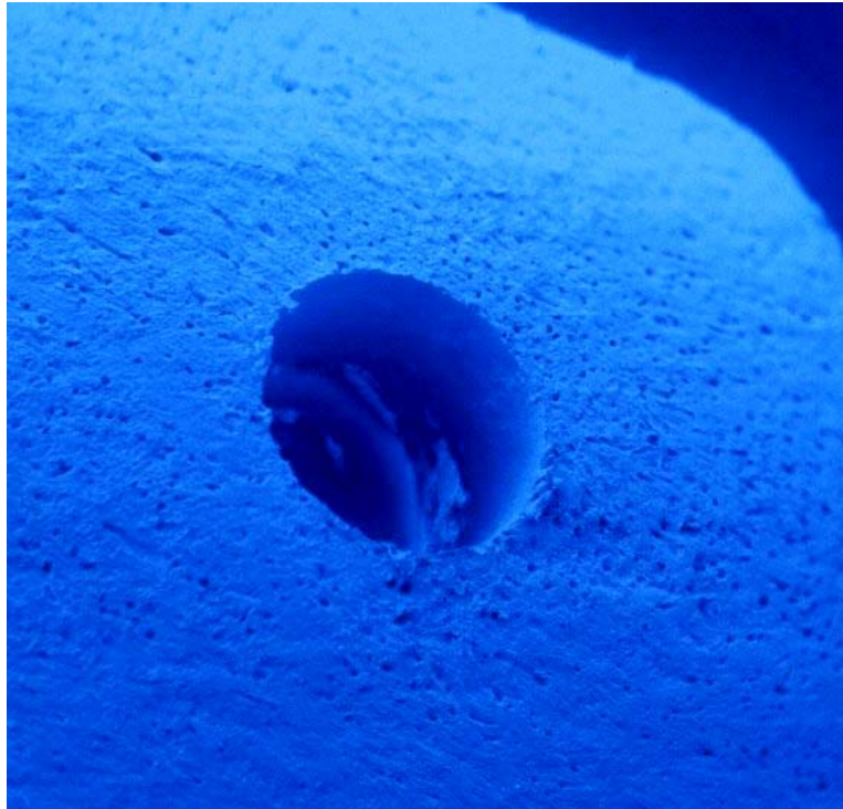
Abb. 28: REM (10fache Vergrößerung), Präzisionsbohrung, ergibt scharfe Übergänge.
