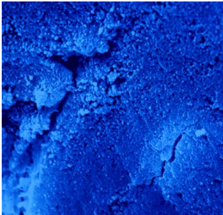
Abb. 34: REM-Ausschnitte aus Abb. 33 (3.000fache Vergrößerung), deutlich erkennbare körnchenartige Auflagerungen und spaltenförmige Unterbrechungen. Keine thermischen Alterationen sichtbar.
