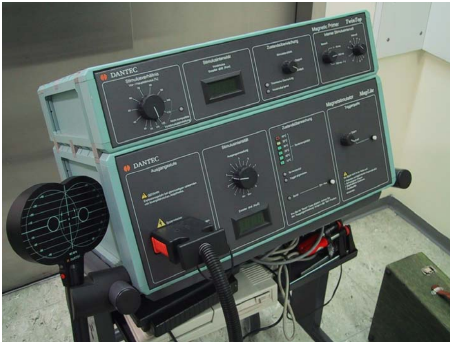
Abbildung 14: Der in dieser Arbeit verwendete MAG-PRO-Stimulator mit Achterspule und Twin-Option der Firma Medtronic-Neuromuscular, Skovlunde, Dänemark
