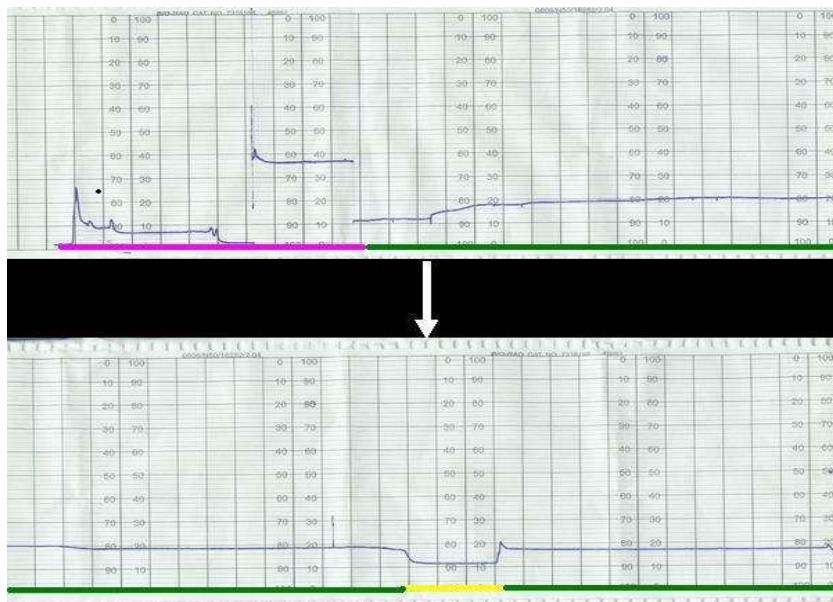
Abb. 32: Beispielhafte Elution für zweite (Fraktion des Elutionspeak in Abbildung 31 eingesetzt) und dritte Elutionsschritte von Progycinin an der Immunaффinitätssäule bei pH 3.
