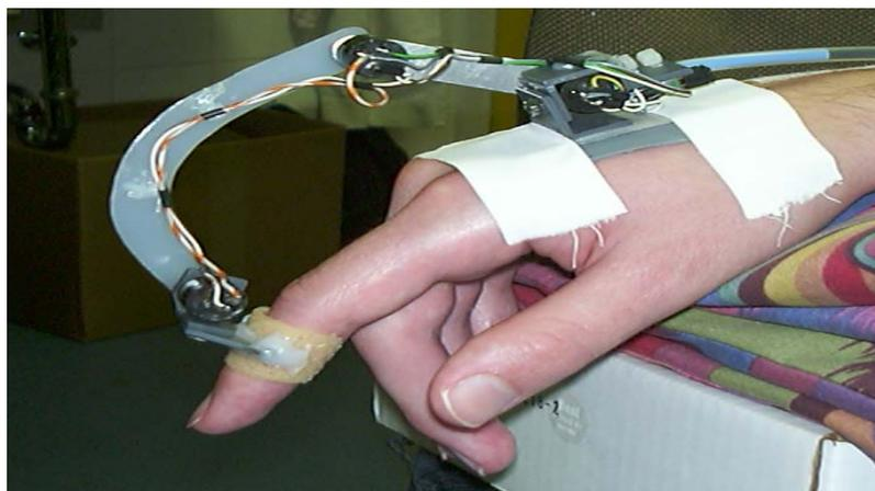
Abb. II.8: Darstellung des Goniometers an der paretischen Extremität während einer Messung, eigene Aufnahme
