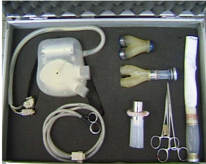
Bild 32: Entwickeltes Unterstützungssystem mit ventrikelförmigen Pumpkammern (Typ II)
