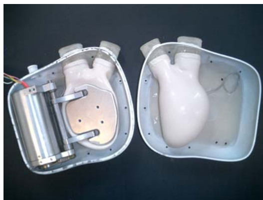
Bild 33: Halbschalen des entwickelten Herzunterstützungsystems LVAS-4
