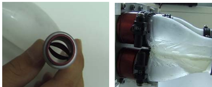
Bild 46 links: St. Jude Zweiflügelklappe mit Pumpschlauch, rechts: Segelventil am Versuchstand
