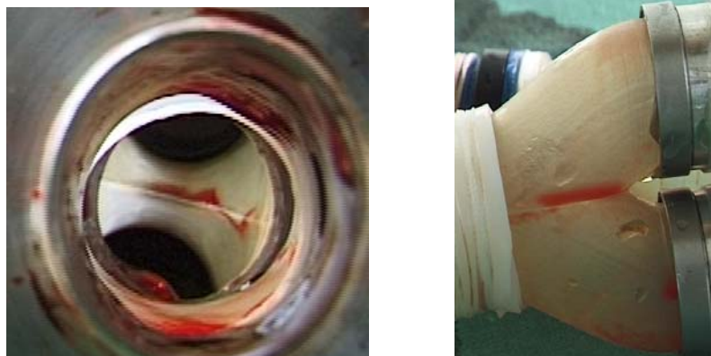
Bild 144: Am Mittelsteg des Y-Adapters wurde ein schmales Band von Thromben beobachtet.
