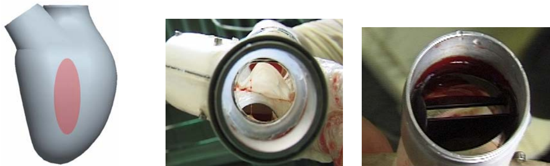
Bild 143: Kritische Bereiche, in denen sich Ablagerungen bilden können. Bild links: Boden der Kammer (rot); Bilde mitte: Segelventil am Auslass (Aortenklappe), Bild rechts: Herzklappenprothese am Einlass (Mitralklappe)
