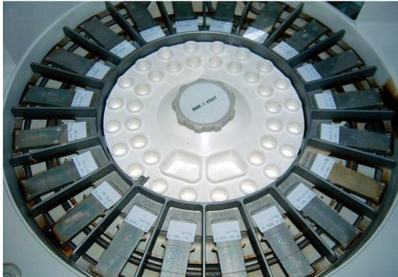
**Abb. 18:** Mit Objektträgern bestückte Färbekammer des Leica Immunostainers. Die für die Färbung benötigten Enzyme und Antikörper wurden in die Fächer in der Mitte eingebracht.
