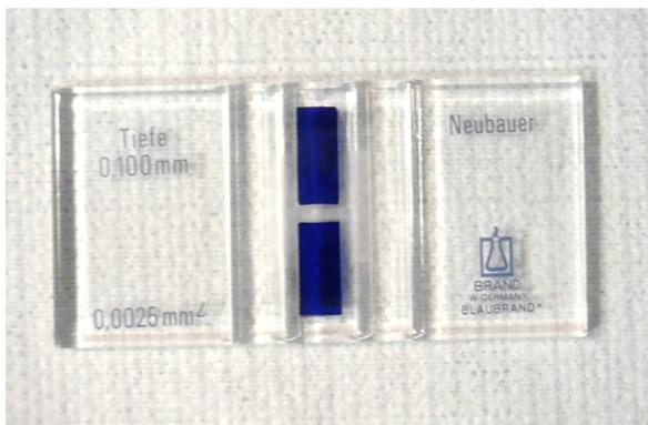
**Abb. 2:** Neubauerkammer. Zur besseren Darstellung der Zählkammern sind diese mit Trypanblau gefüllt.
