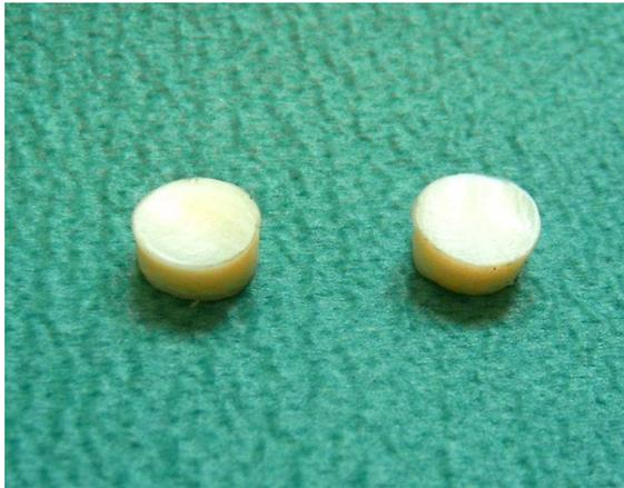
**Abb. 12:** Zylinder aus dem medialen Meniskus eines bovines Kniegelenkes. Höhe 4 mm, Durchmesser 10 mm.
