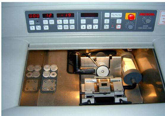
**Abb. 17:** Ansicht des Kryotoms mit Blick in die Schneidekammer. Links im Bild befindet sich die Schnellgefrierplatte. Im Zentrum die Objekthalterung, davor die Schneidevorrichtung.
