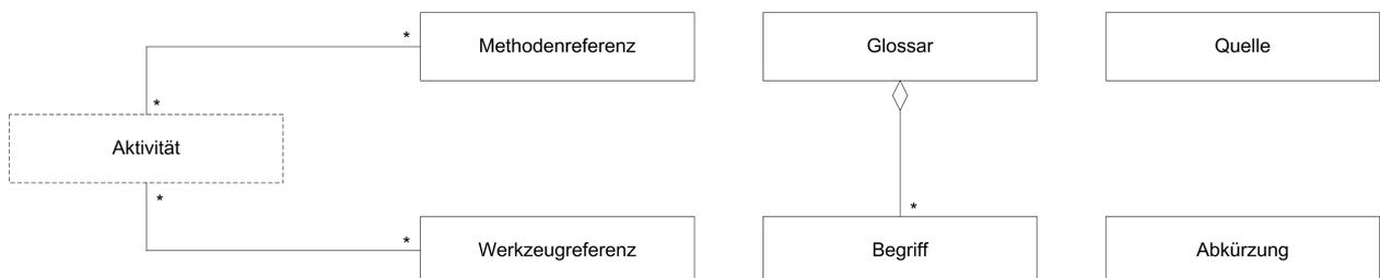
Abbildung B.13: Metamodell der Unterstützenden Elemente (Quelle [132], eigene Darstellung)
