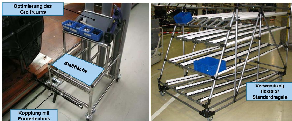
Abbildung 6-11: Mitfahrender Materialwagen (li.) und Durchlaufregal auf Rollen (re.) aus Standardelementen [Kab-06]
