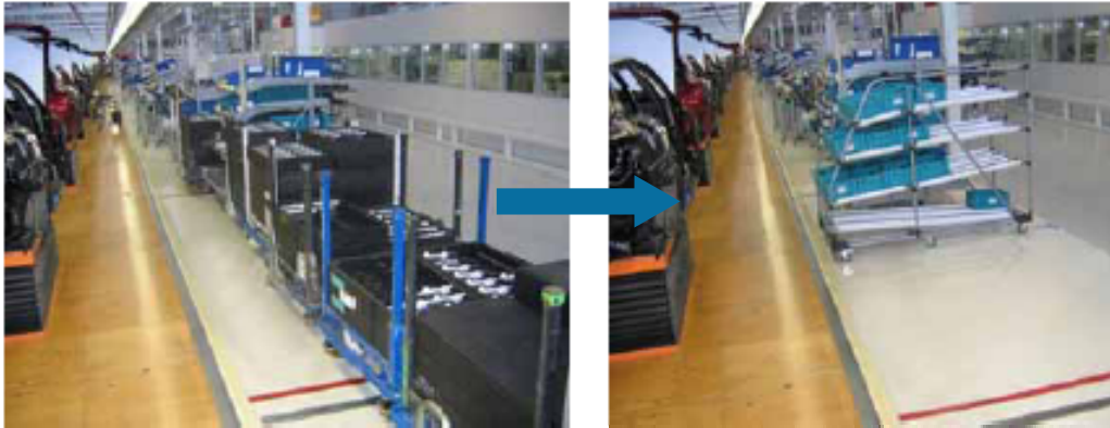
Abbildung 6-8: Minimierung des Flächenbedarfs durch Auswahl geeigneter Kleinladungsträger [Hei-07]
