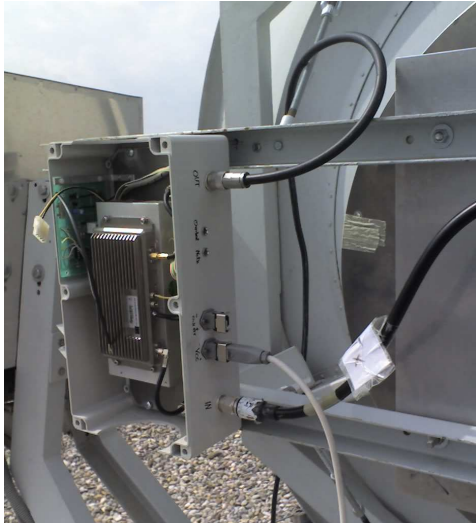
Abb. 3-14: Geöffnete Schutzbox für den Leistungsendverstärker vor der Endmontage
