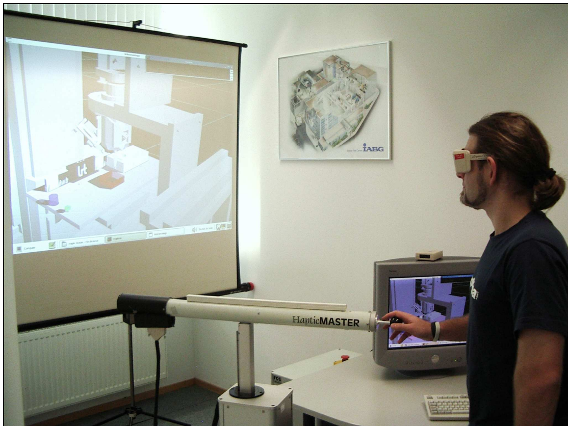
Abb. 3-21: Installiertes HapticMaster-Manipulationssystem am Lehrstuhl Raumfahrttechnik mit entsprechendem Szenario
