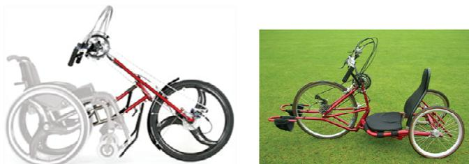
Abb. 8: Handbike-Typen: links Adaptivbike, rechts Racebike (Firma Speedy Rehatechnik, Delbrück; Quelle: <http://www.speedy.de/>)
