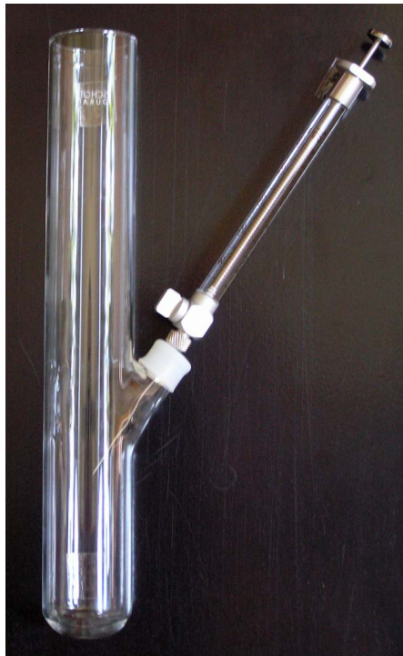
Abbildung 2.4: Spezialglas zur sterilen Applikation von AHL und Entnahme von Proben. Der seitliche Auslass wurde mit einem autoklavierbaren Silikonseptum verschlossen. Applikation und Entnahme erfolgten mittels steriler Hamilton-Spritzen.
